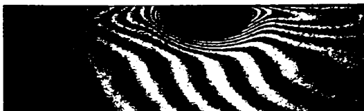
Figura 5.5.4 Interferograma corespunzătoare unei bule de vapori obținute cu ajutorul celulei de testare 2. Curentul prin folia încălzitoare fiind de 3A, o temperatura a lichidului în colțul din stânga jos de 23°C, lichidul folosit fiind un refrigerant R141b (nu se cunoaște puritatea și calitatea lichidului folosit)
