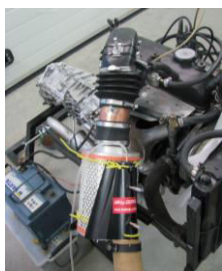
Figura 3.55. Testarea sistemului dinamic de transfer al aerului (SDTA): a,b – SDTA, c – stand
