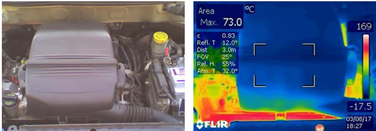
Figura 4.12. Câmpul termic pe carcasa filtrului de aer
