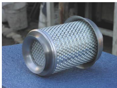
Figura 3.56. Testarea filtrului supraaspirant cu arie extinsă de filtrare: a – filtru supraaspirant cu arie extinsă de filtrare, b – stand
