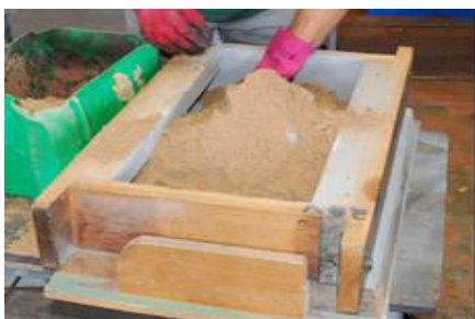
Figura 5. Introducerea nisipului în cutia de modelare
