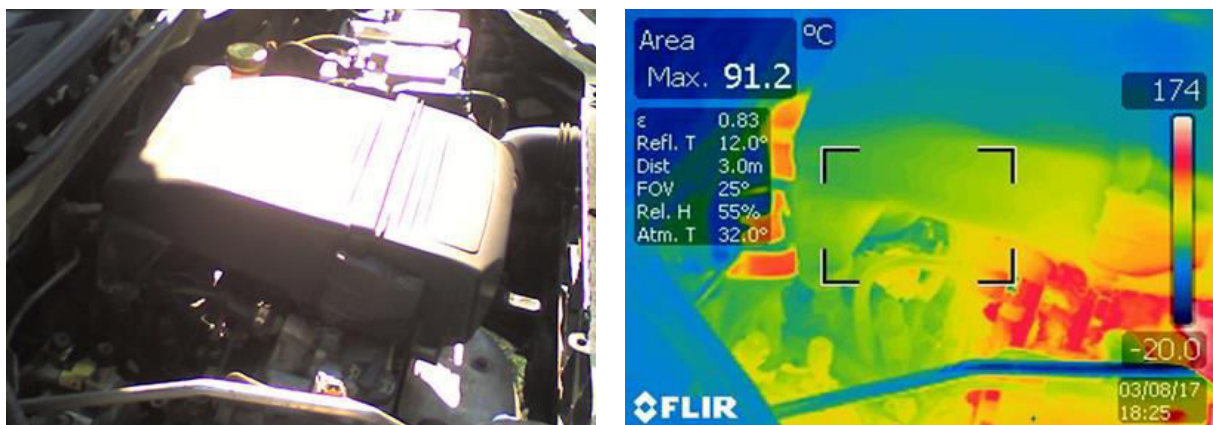
Figura 4.13. Câmpul termic în zona galeriei de admisie
