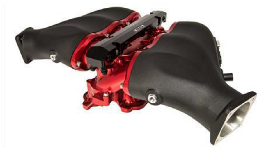
Figura 1.20. Galerie de admisie din aliaj de aluminiu realizată prin prelucrări mecanice
