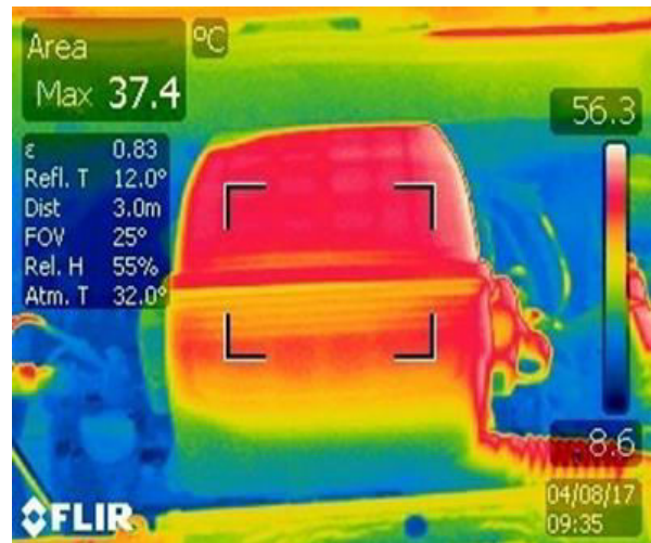
Figura 4.7. Câmpul termic pe carcasa filtrului de aer
