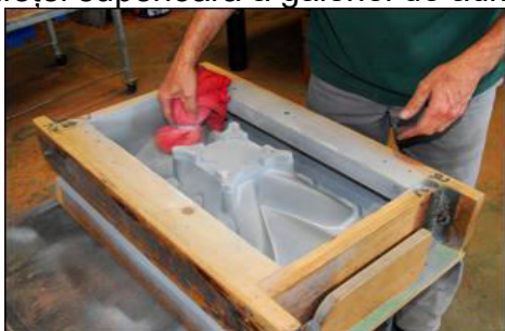
Figura 3. Aplicarea prafului de talc pe model
