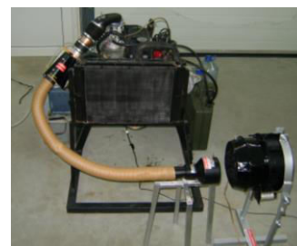
Figura 3.55. Testarea sistemului dinamic de transfer al aerului (SDTA): a,b – SDTA, c – stand
