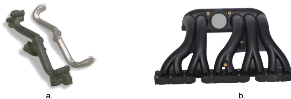
Figura 1.27. Metoda miezului pierdut : a – piesa și miez, b – galerie de admisie cu miezul în interior
