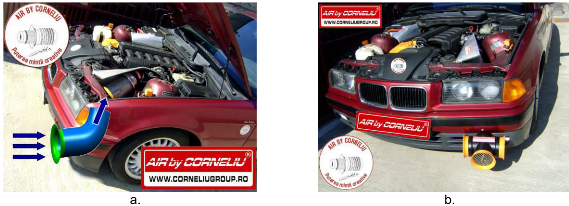
Figura 3.29. Sistem dinamic de transfer al aerului, BMW E36: a - circulația aerului BMW E36, b - sistem difuzoare triplu, BMW E36
