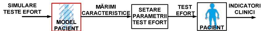
Fig.1.1 Utilizarea modelului SCV pentru obținerea protocolului testului de efort a unui pacient
