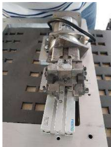
Fig. 4.56. Sistemul de fixare a motorului electric cu excentric
