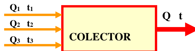
Figura 4.2: Schema bloc a colectorului pentru tur (retur)
