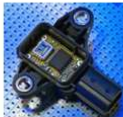
Senzor presiune absolută 0.5 până 1.35 bar [2]
