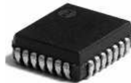
Senzor accelerație micro-mecanic, \pm 50g [1]
