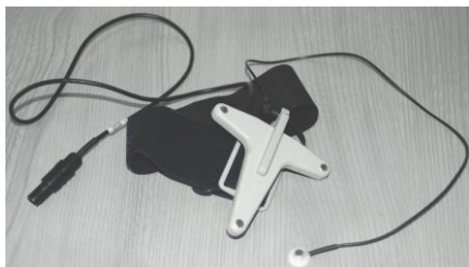
Fig. 2.16. Setul de markeri pentru membrele superioare GS-UHS
