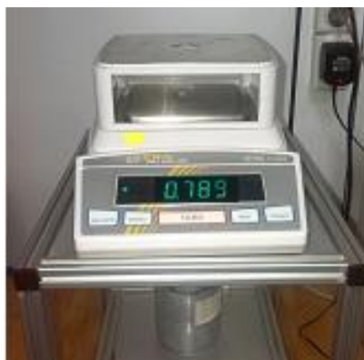
Fig. 4.39. Determinarea masei unei piese a componente de polietilenă cu Balanța Kern PRJ620-3M
