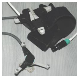
Fig. 2.17. Setul de markeri pentru membrele inferioare GS-DHS
