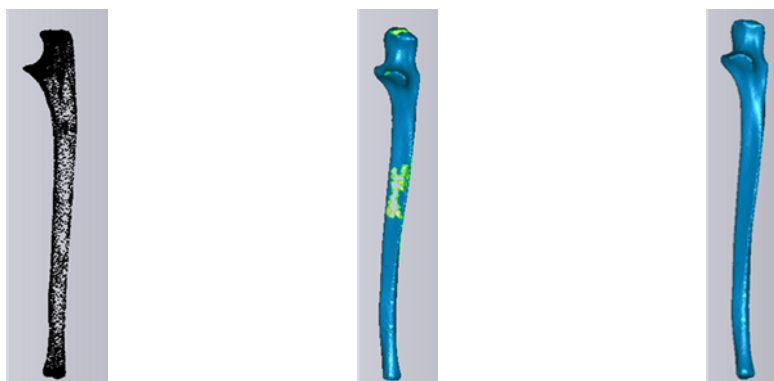
a) Modelul nor de puncte b) Înfășurătoare suprafeței c) Reconstrucția finală Fig. 3.11. Îmbunătățirea reconstrucției osului ulna
