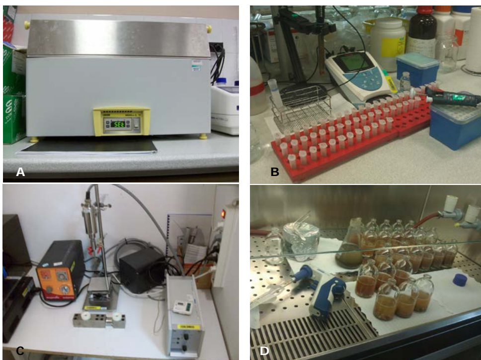
Figura 5.4. Realizarea diferitelor strategii de pretratament a consorțiilor inițiale de microorganisme; A - pretratamentul cu căldură în baie de apă, B - pretratamentul cu acid utilizând HCl 1N, C - pretratamentul prin ultrasonicare utilizând ultrasonicatorul, D - inocularea consorțiilor microbiene după aplicarea pretratamentelor.
