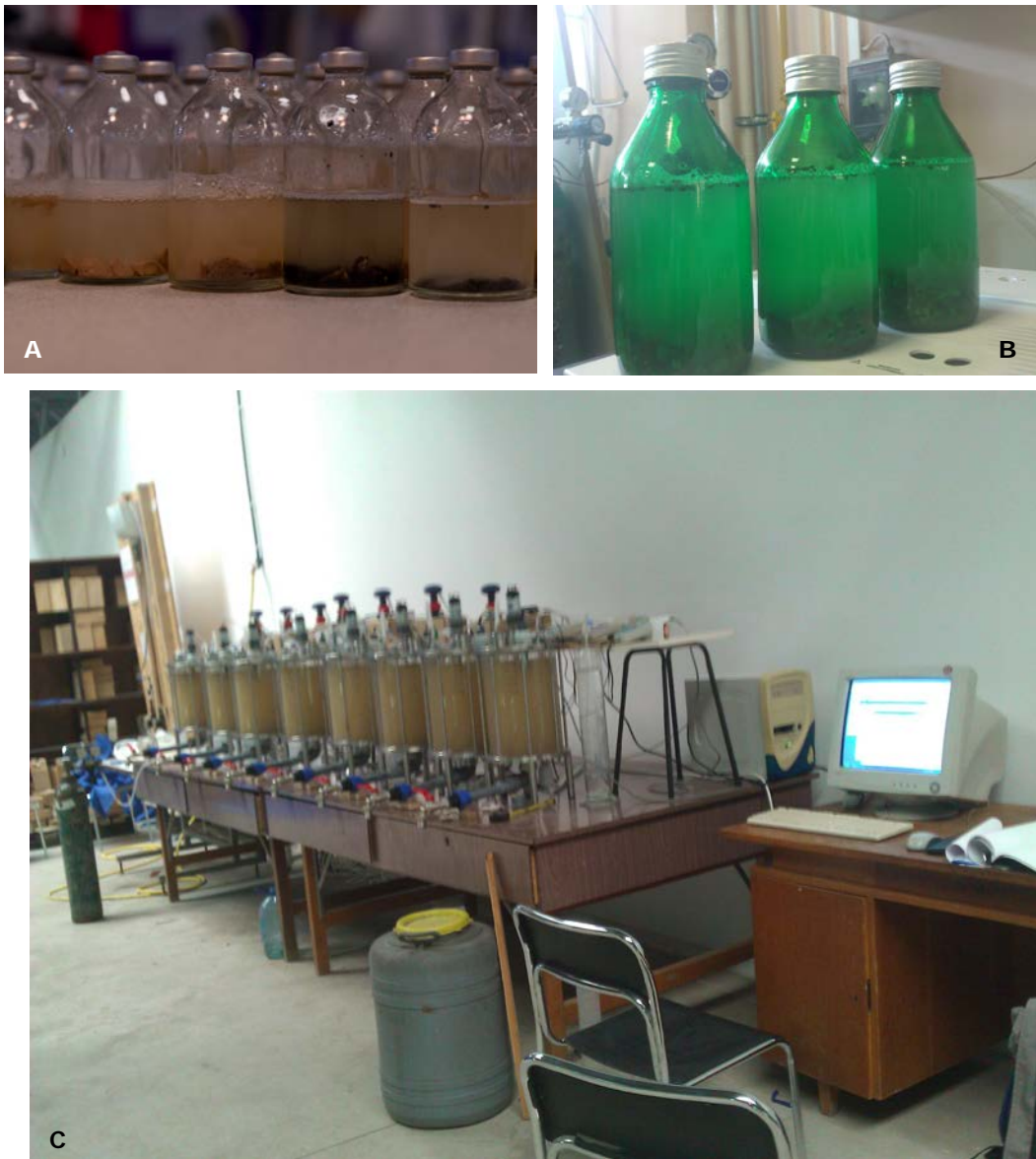
Figura 5.13. Răspunsurile diferite obținute în urma degradării apei uzate rezultate în urma proceselor tehnologice de producere a berii, în cadrul matricilor experimentale propuse, la nivelul bioreactoarelor de dimensiuni mici (A), medii (B) și respectiv mari (C).
