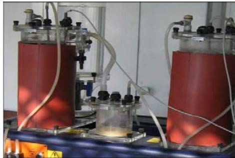
Figura 5.2. Instalația experimentală Armfield, alcătuită din două digestoare anaerobe de contact cu suport (fix sau mobil) sau fără suport, ce pot funcționa atât în paralel cât și în serie, în regim continuu sau staționar; instalația este prevăzută cu sistem de control și monitorizare al temperaturii din digestoare, pompe pentru circulația fluidelor și recipiente prevăzute cu lichid, utilizate în captarea și contorizarea în paralel a biogazului produs.
