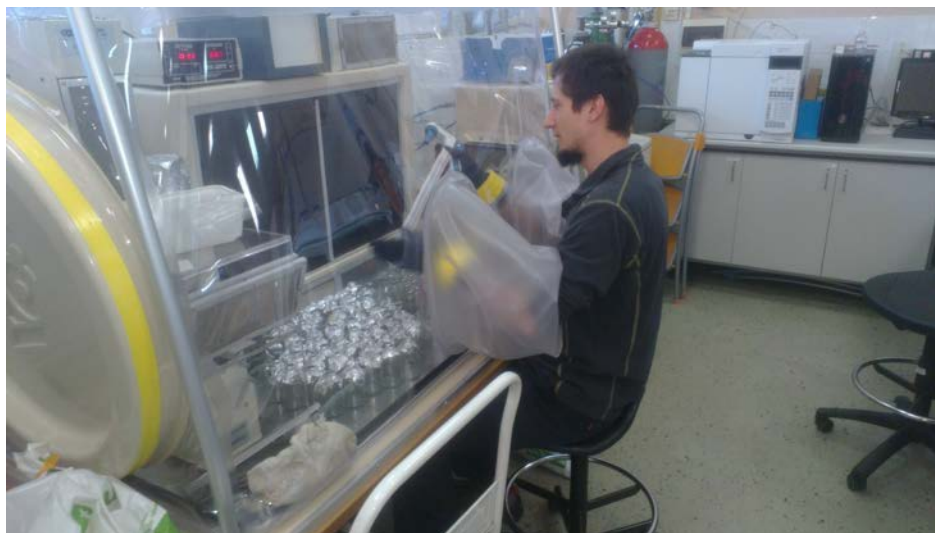
Figura 5.9. Inocularea în mediu lichid de îmbogățire DMI a microorganismelor utilizate în experimentele de producție a biohidrogenului în urma degradării apei uzate, utilizând hota microbiologică anaerobă.
