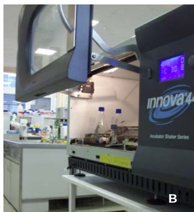
Figura 5.10. Inocularea apei uzate sintetice folosind microorganismele pretratate și îmbogățite în prealabil în mediul lichid de îmbogățire DMI, utilizând hota microbiologică anaerobă (A) și fermentarea acestora în condiții controlate de temperatură și agitare (B).
