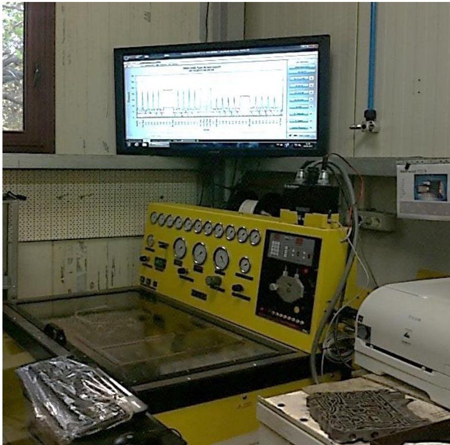
Figura 4.17. Standul modulului de comandă a CVA pentru determinarea parametrilor funcționali ai ambreiajelor și frânelor împreună cu sistemul de vizualizare a datelor preluate
