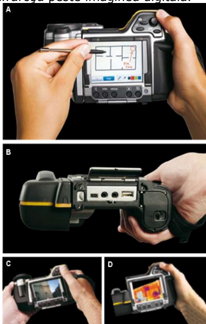
Figura 5.3. – Aparatul FLIR B200 utilizat în studiului termografic. A – fața posterioară a aparatului cu display-ul și setarea acestuia. B – fața inferioară a aparatului cu hub-urile de conectare. C – imagine fotografică normală la nivelul display-ului. D – imagine termografică a aceluiași obiect din detaliul C.
