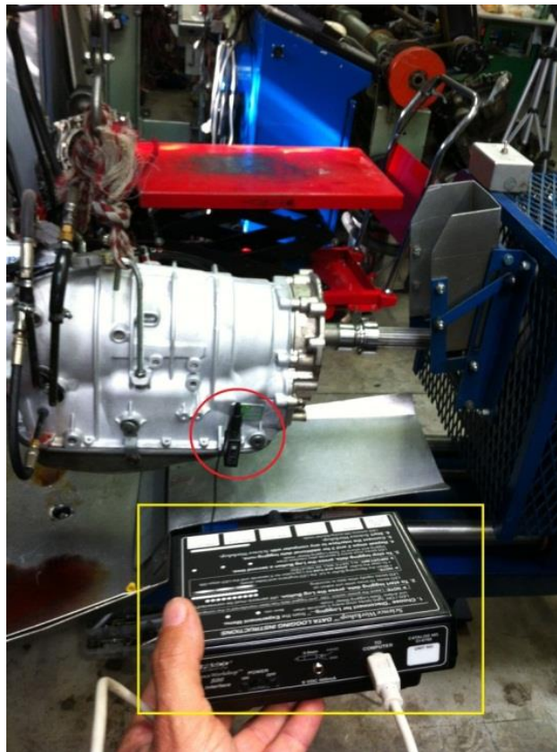
Figura 5.33. Accelerometrul montat pe standul de testare împreună cu placa de achiziție de date
