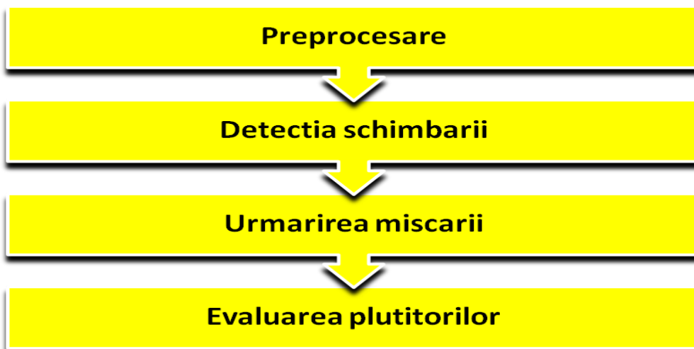
Figură 4-2 Schema bloc de detectare a plutitorilor
