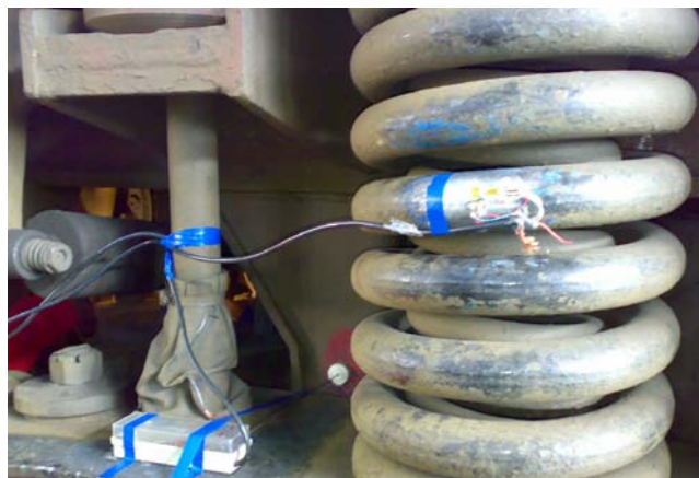
Fig. 6-8. Situația punctelor de măsurare pe grinda longitudinală a patruilaterului articulată
