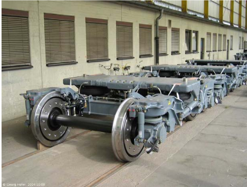
b) Fig. 1-14. Boghiu tip Graz: a) suspensia din arcuri elicoidale, b) suspensia primară: arcuri elicoidale, suspensia secundară: pernă de aer.
