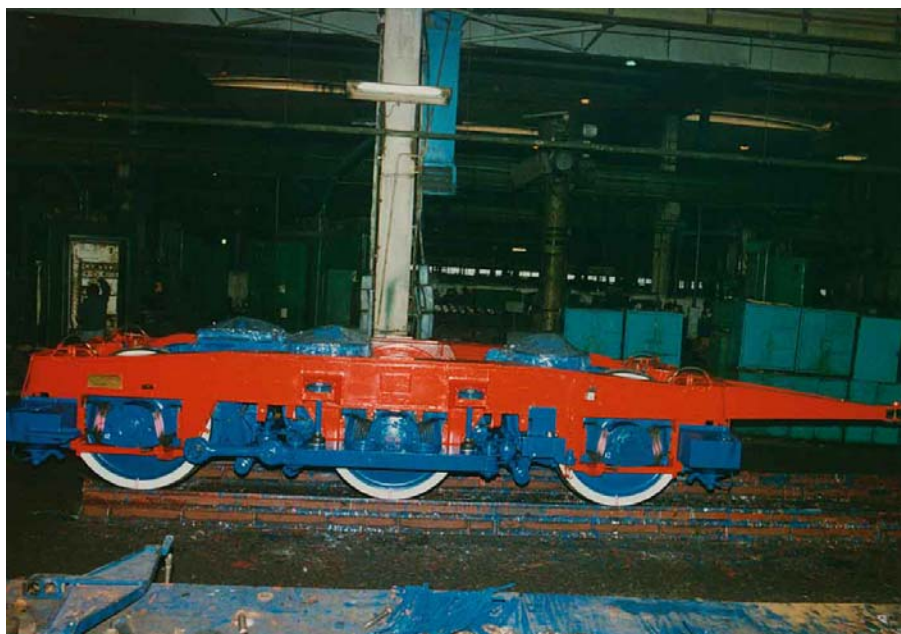
Fig. 1-22. Boghiul locomotivei electrice CFR 060-EA de 5100 kW
