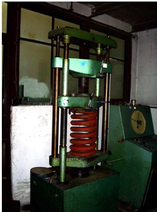
Fig. 6-2. Mașina de încercat ZD 40: încercarea arcului exterior
