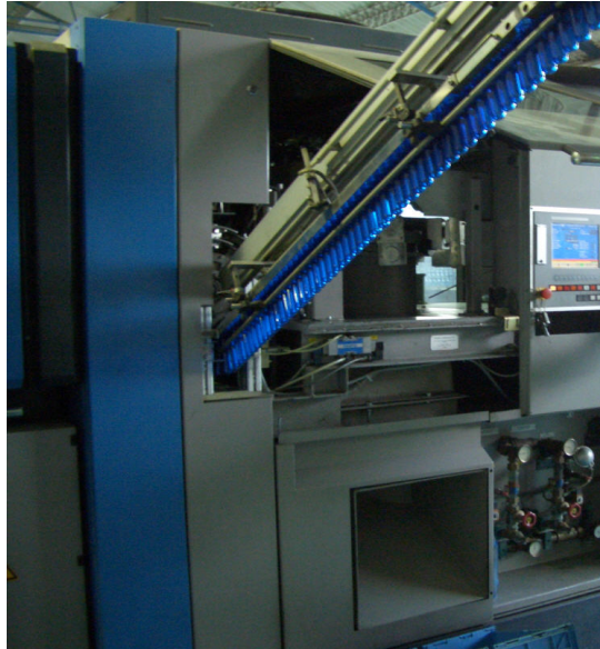
Figura 1.14. Șinele de transport a preformelor
