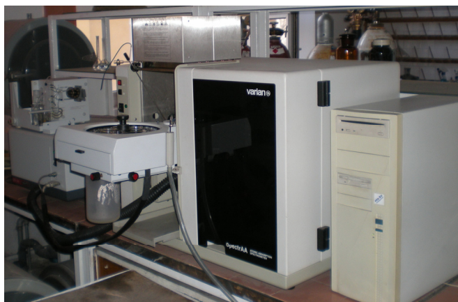
Figura 2.70. Spectrometru de absorbție/emisie atomică în flacără VARIAN Spectr AA 110
