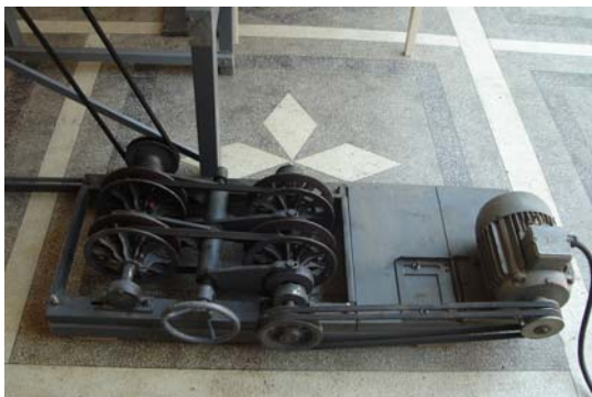
Figura 5.3. Intercalarea variatorului de turație în cadrul standului experimental
