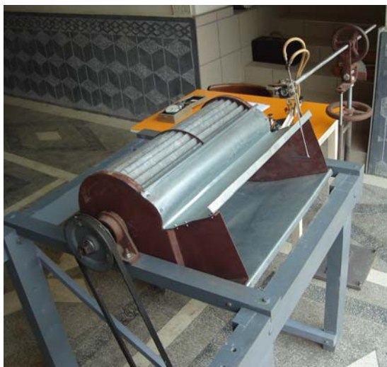
Figura 6.10. Vedere de ansamblu a primei variante a ventilatorului în timpul efectuării măsurătorilor în secțiunea finală de refulare
