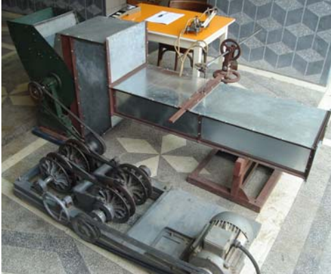
Figura 5.5. Vedere de ansamblu a standului destinat experimentării ventilatorului transversal cu tubulatură de aspirație și cameră de sedimentare
