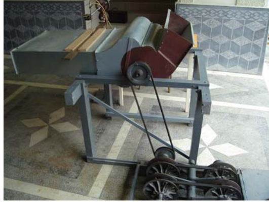
Figura 5.6. Vedere de ansamblu a standului destinat experimentării ventilatorului transversal cu tubulatură și zonă de racordare a tubulaturii la fereastra de aspirație
