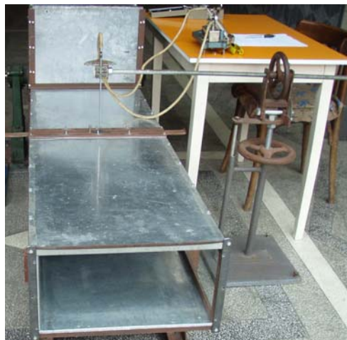
Figura 5.8. Vedere de ansamblu a dispozitivului coordonator al tubului Pitot-Prandtl în timpul măsurătorilor în tubulatura de aspirație a ventilatorului transversal varianta a IV-a
