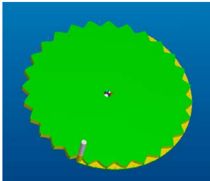
Figura 2.16. Prelucrarea exterioară a discului de susținere a paletelor
