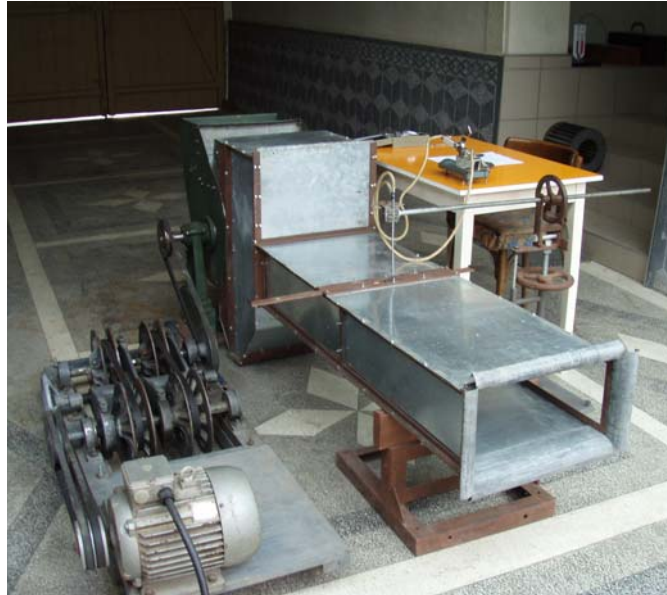
Figura 6.14. Vedere de ansamblu a standului în timpul efectuării măsurătorilor în tubulatura de aspirație
