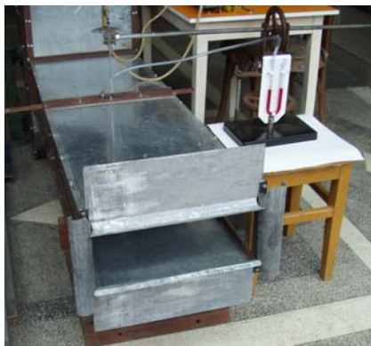
Figura 6.16. Detaliu constructiv privind echiparea tubulaturii de aspirație pentru ridicarea caracteristicii energetice a ventilatorului
