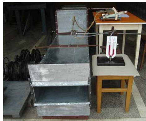
Figura 6.17. Vedere de ansamblu a standului în timpul efectuării măsurătorilor necesare construirii caracteristicii energetice a ventilatorului
