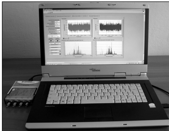
Fig.6.23. Funcționarea aplicației pentru localizarea surselor de zgomot
