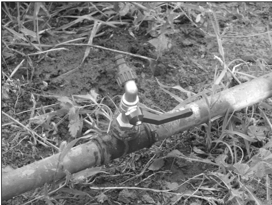
Fig.3.2. Robinetul care simulează fisura
