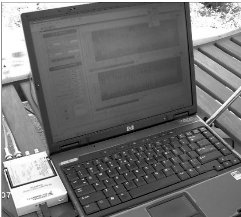
Fig.3.4. Achiziția semnalelor cu placa NI USB 9215A și aplicația implementată în LabVIEW
