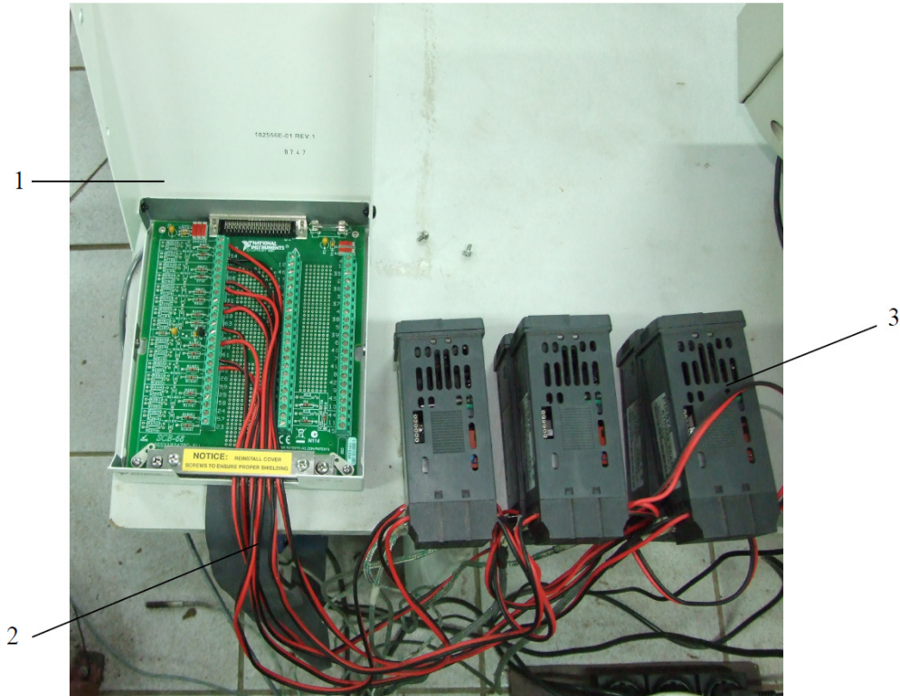
Figura 5.29. Legăturile convertoarelor la blocul cu interconexiuni: 1-bloc de interconexiuni, 2-conexiuni, 3-convertoare digital analogice.
