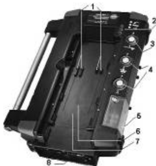
Figura 5.43. Unitatea de analiză, vedere de sus [114]: 1 - contactoare electrice; 2 - leduri de control; 3 - filtrul pentru particule solide; 4 - filtre de reținere particule din aerul aspirat; 5 - colectoare de condens; 6 - celule de analiză; 7 - sistem integrat de determinare a vitezei și presiunii gazelor; 8 - conexiuni.
