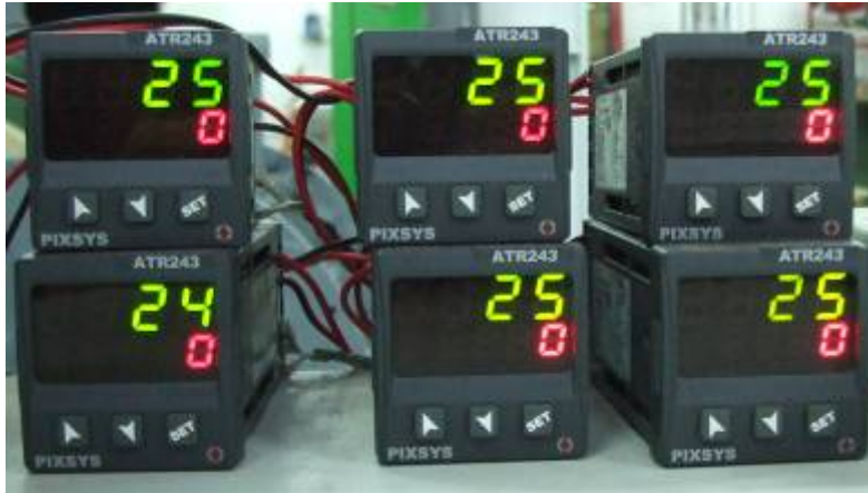
Figura 5.26. Exemplu de vizualizare a temperaturilor cu convertorul Pixsys ATR 243 ABC.
