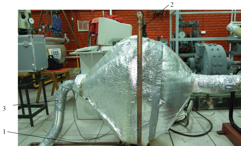
Figura 5.17. Ajutaj divergent convergent izolat cu vată minerală și burete cu folie de aluminiu:
