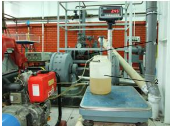
Figura 5.53. Cântarul instalației experimentale: 1 - rezervor, 2 - cântar.
