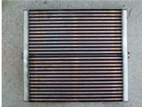
Figura 5.12. Vedere a schimbătorului de căldură.
