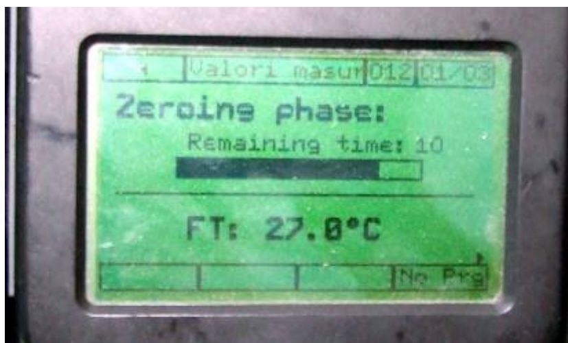
Figura 5.47. Screenshot ce indică momentul de calibrarea la zero a analizorului.
