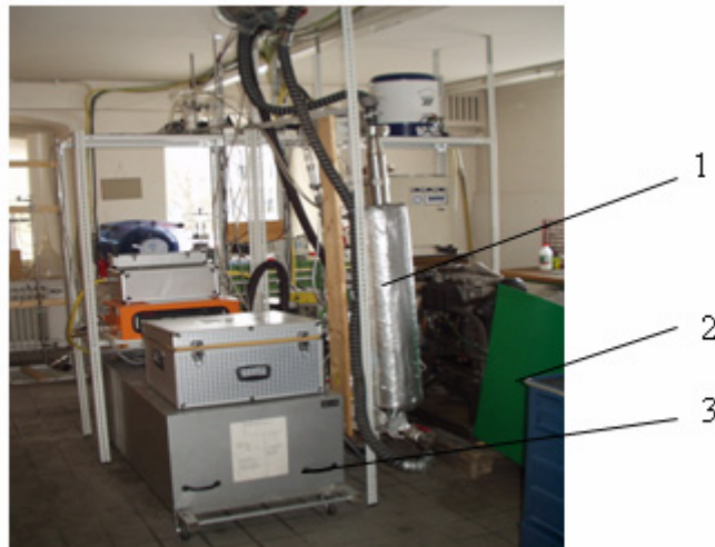
Figura 3.7. Subansamblul standului experimental cu microcentrală în cogenerare [72]:
