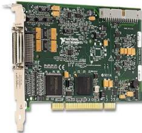
Figura 5.27. Vedere de sus a plăcii de achiziție de date [94].
