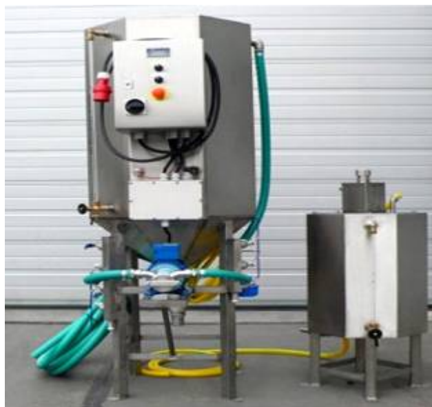
Figura 3.2. Instalație BK 300 SS de producere a biodieselului [80].
