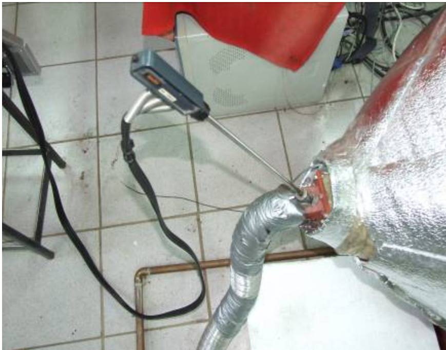
Figura 5.39. Punctul de măsurare a noxelor.
