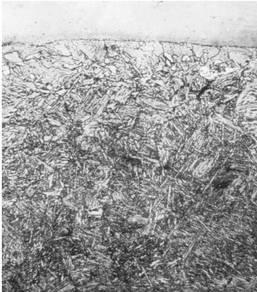
Fig. 2.6. Microstructura probelor nitrurate din oțel 42CrMo4 ; 500x
