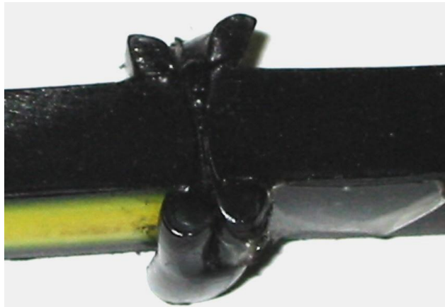
Figura 4.11 – Aspectul macroscopic al unei probe extrase dintr-o îmbinare de țevi din PE 80, sudată cap la cap cu element încălzitor, ce prezintă un defect plan simulat printr-o bandă adezivă plasată la interfața de separație a componentelor [79]
