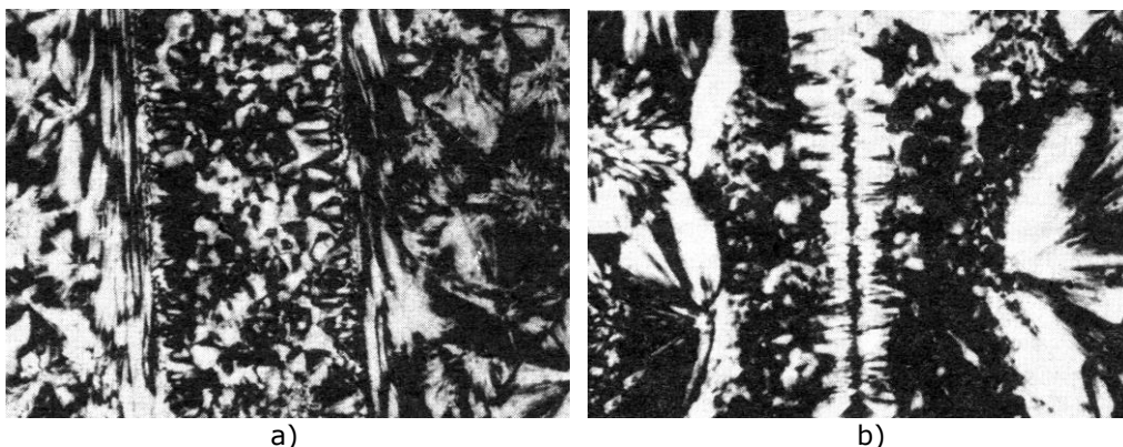
Figura 2.24 Micrografie în lumină polarizată, a epruvetelor tip șlifuri subțiri din polipropilenă, extrase din îmbinarea cap la cap ( \times 200 ; reducere \frac{3}{4} ) [32]:
