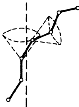
Figura 2.20 Penetrarea macromoleculilor de polimer prin suprafața de separare a epruvetelor sudate, provocată de modificarea formei lanțurilor de polimeri [32]
