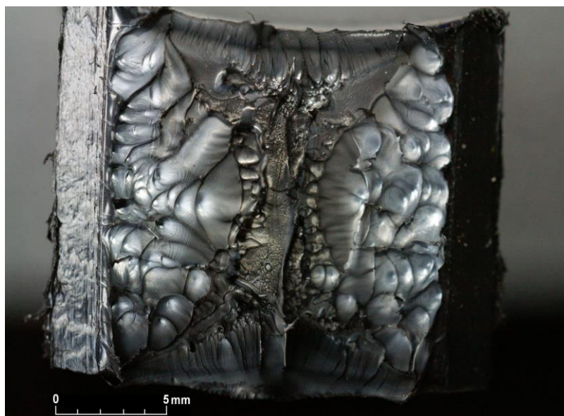
Figura 7.19 – Suprafața de rupere a unei epruvete cu creștături în V bilaterale cu adâncimea h=2,0 mm, ce ocupă 20% din secțiunea transversală a epruvetei, v=650 mm/min; T=23^{\circ}\text{C} [78]
