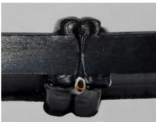
Figura 4.13 – Aspectul macroscopic al unei probe extrase dintr-o îmbinare de țevi din PE 80, sudată cap la cap cu element încălzitor, ce prezintă un defect volumic simulat printr-un implant realizat dintr-un tub PVC [79]
