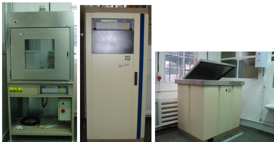
Figura 6.1 – Instalație de încercare la presiune la temperatură constantă [80] a) Cuptor de încercare; b) Modul de presurizare; c) Baie termostată
