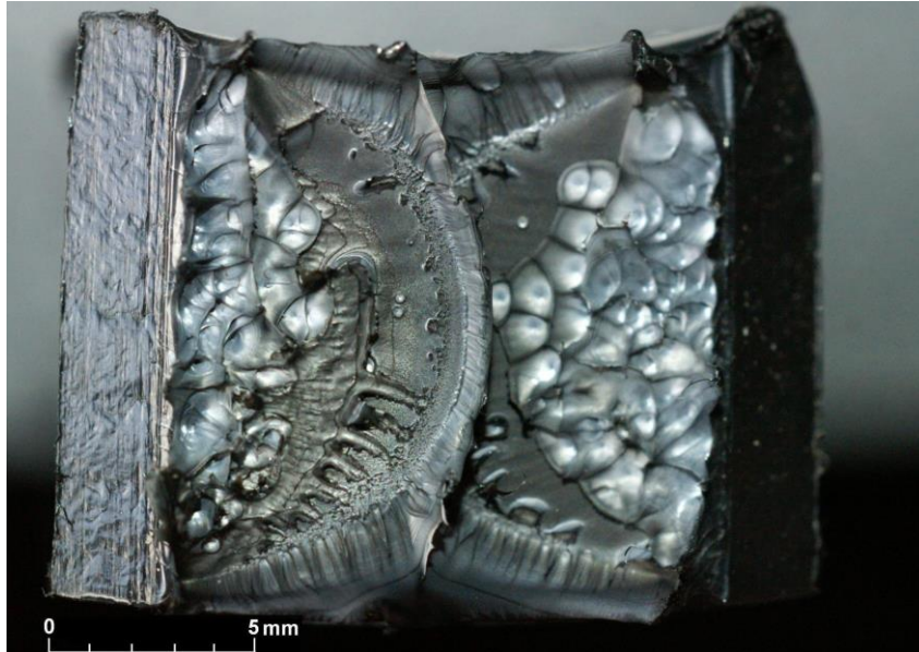
Figura 7.21 – Suprafața de rupere a unei epruvete cu creștături în V bilaterale cu adâncimea h=2,5 mm, ce ocupă 25% din secțiunea transversală a epruvetei, v=650\text{mm/min} ; T=23^\circ\text{C} [78]
