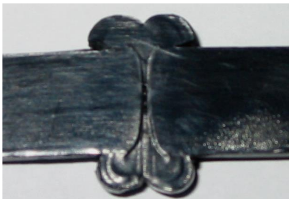
Figura 4.16 – Defect artificial plan, simulat prin tehnica tăierii LASER a unei îmbinări sudate cap la cap cu element încălzitor dintre două țevi din PE 80 [79]
