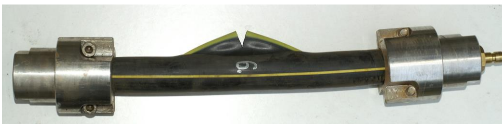
Figura 6.4 – Rupere ductilă – Material de bază [80]
