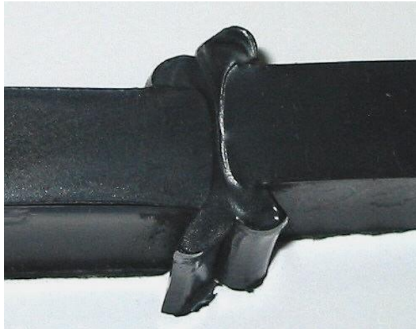
Figura 4.6 – Aspectul macroscopic al unei probe extrase dintr-o îmbinare de țevi din PE 80, sudată cap la cap cu element încălzitor, ce prezintă un defect de aliniere [79]
