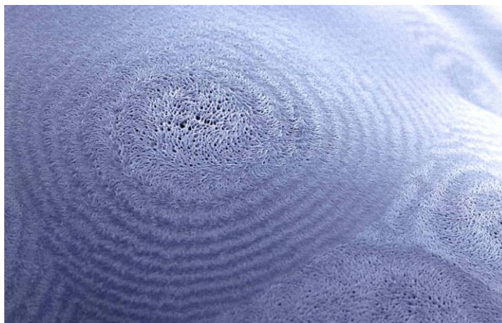
Figura 1.23 - Suprafața sferulitei inelare de polietilenă, examinată prin tehnica SEM (Scanning Electron Microscopy) [64]
