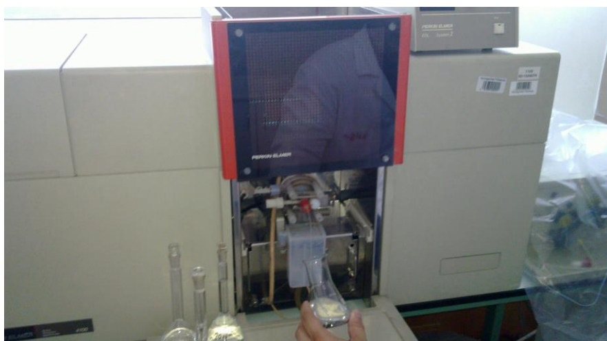
Figura 3.15 Spectrometru Perkin-Elmer 4100 cu flacără [arhivă proprie]
