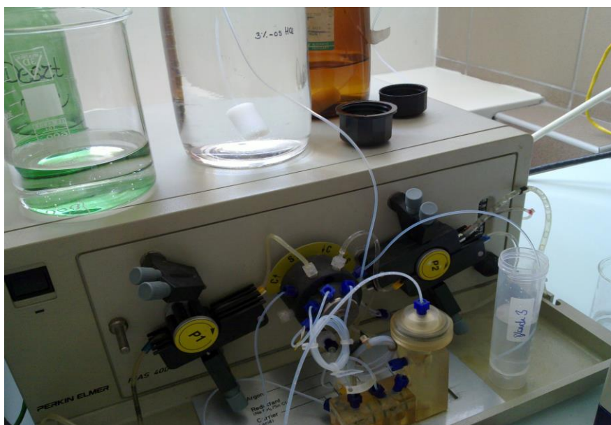
Figura 3.19 Spectrometru Perkin-Elmer FIAS-400 [arhivă proprie]
