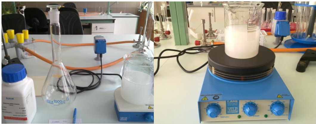
Figura 3.30:a) Pregătire soluție purtătoare HCl; b) Plită cu agitator magnetic [arhivă proprie]
