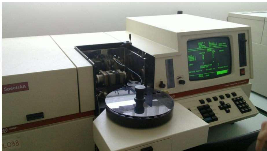
Figura 3.16 Spectrometru Varian Techtron SpectrAA-20 cu cuptor de grafit [arhivă proprie]
