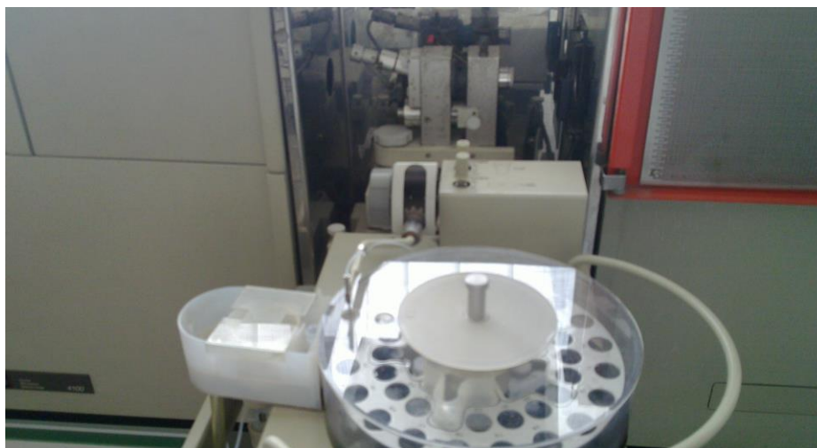
Figura 3.17 Spectrometru Perkin-Elmer 4100 cu cuptor de grafit [arhivă proprie]
