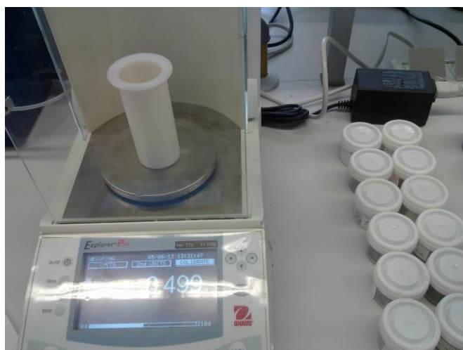
Figura 3.9 Dozarea mostrelor pentru analiza de laborator [arhivă proprie]
