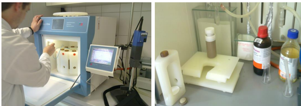
Figura 3.10 Cuptorul pentru dezagregarea probelor ETHOS One [arhivă proprie]
