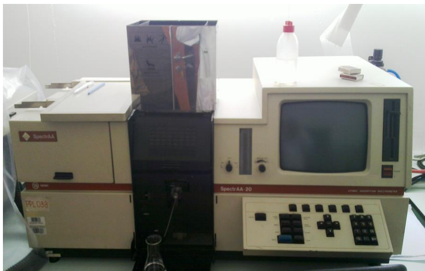
Figura 3.14 Spectrometru Varian Techtron SpectrAA-20 cu flacără [arhivă proprie]
