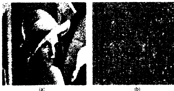
Fig. 2.9: Marcaj DWT dependent de conținutul imaginii. (a) Imagine puternic marcată, și (b) Diferența W(x,y)=I(x,y)-I_w(x,y)
