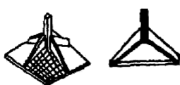
Fundație izolată din paraboloidi hiperbolici din beton armat monolit sau prefabricat: -India
