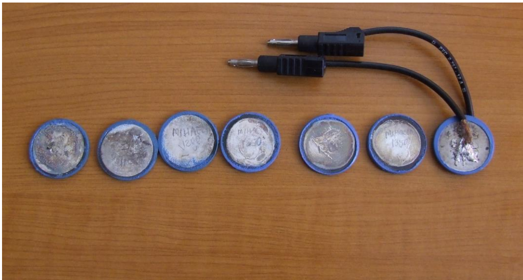
Fig.5.2. Varistoare cu 5 oxizi aditivi, sinterizate la temperaturi diferite
