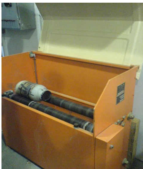
Fig. 4.3. Instalația de măcinare și amestecare
