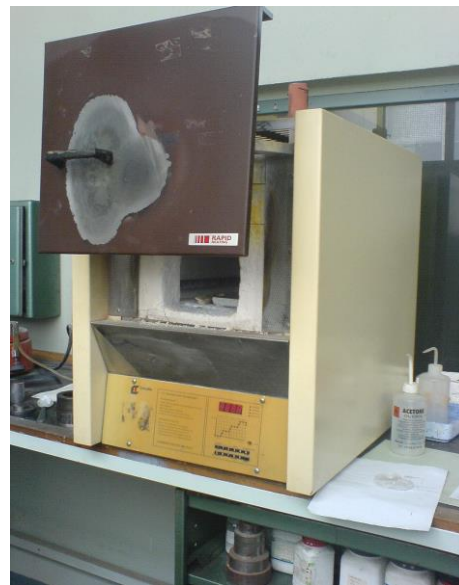
Fig. 4.6.b. Cuptorul programabil pentru temperaturi ridicate
