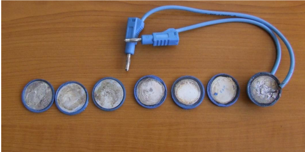
Fig.5.1. Varistoare cu 2 oxizi aditivi, sinterizate la temperaturi diferite
