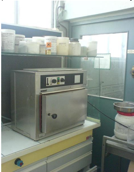
Fig. 4.6.a. Instalația pentru realizarea primului palier de încălzire
