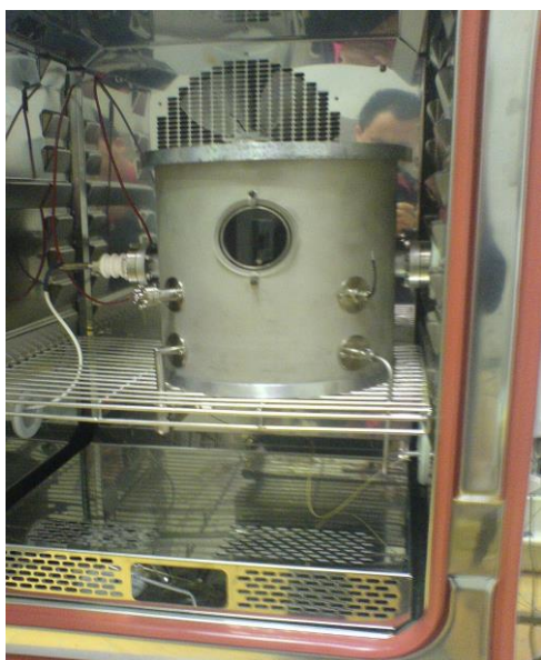
Fig. 4.5.a. Etuva pentru uscare și încălzire ușoară
