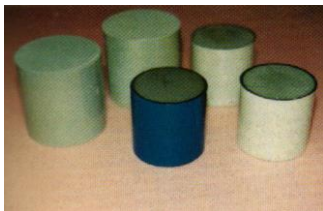
Figura 2.21: Serie de varistoare pe bază de ZnO
