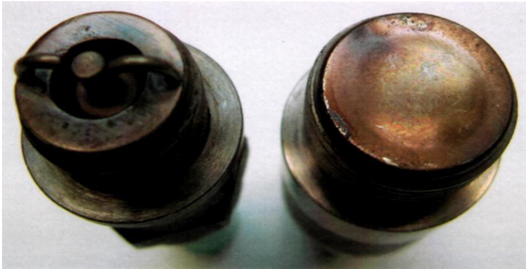
Fig.4.25.Bujia și senzorul de detonație folosite de echipamentul YHT-85 după 10 ore de funcționare cu benzină A-95 netratată
