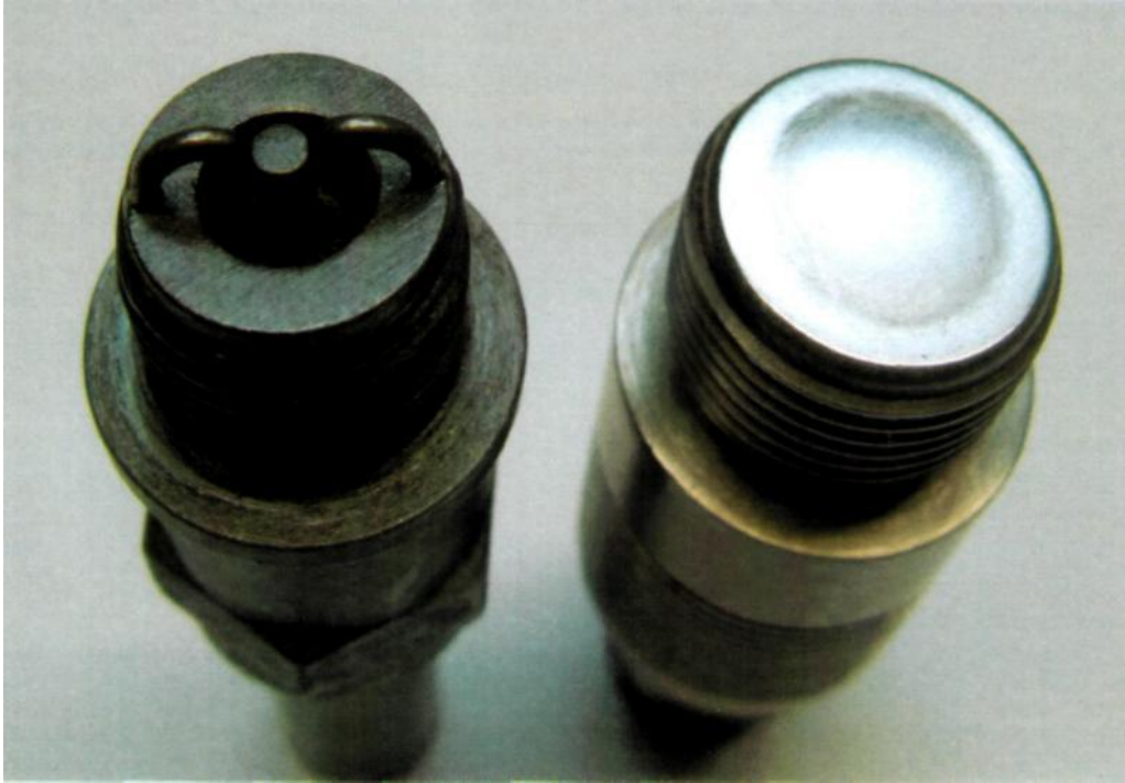
Fig.4.24.Bujia și senzorul de detonație folosite de echipamentul YHT-85 înainte de începerea testului (curate, fără funingine)
