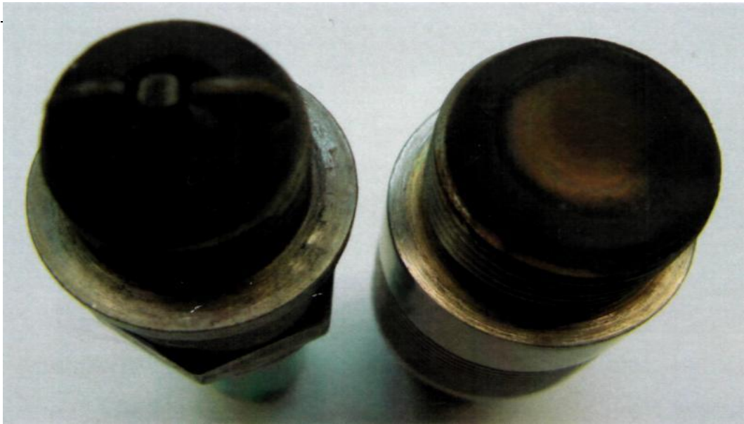
Fig.4.25.Bujia și senzorul de detonație folosite de echipamentul YHT-85 după 10 ore de funcționare cu benzină A-95 netratată
