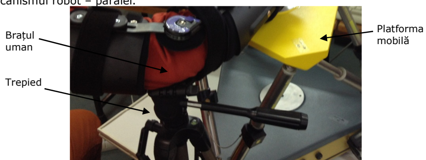
Fig. 6.34 Conexiunea creată pentru materializarea pseudo-elementului fix
