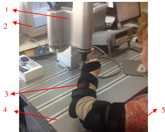
Fig. 4.13 Stand experimental: 1) Robot SCARA Y K 400 X; 2) PC; 3) Orteză articulația cotului 4) Masă de lucru; 5) Pacient
