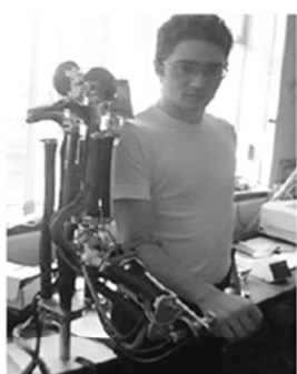
Fig. 2.18 Exoschelet atașat la mâna unui pacient [Tsagarakis, 2003]
