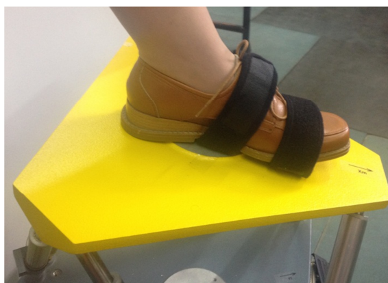
Fig. 6.37 Conexiunea creată pentru materializarea lanțului cinematic mixt în exercițiul de recuperare flexie - extensie
