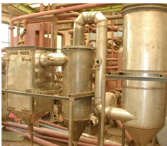
Fig. 4.20. Racord corp convectiv-ciclon, respectiv ciclon-scruber
