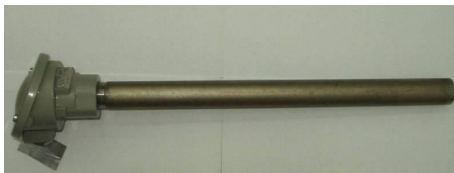
Fig. 4.38. Termocuplu tip K ( t_{\max}=1372 °C)
