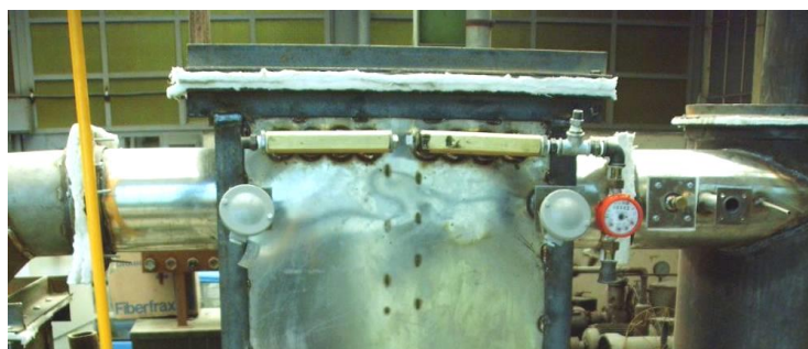
Fig. 4.19. Racord focar-corp convectiv, respectiv corp convectiv-ciclon
