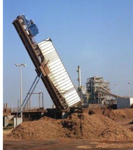
Fig. 3.20. Descărcarea așchiilor din camioane[91]
