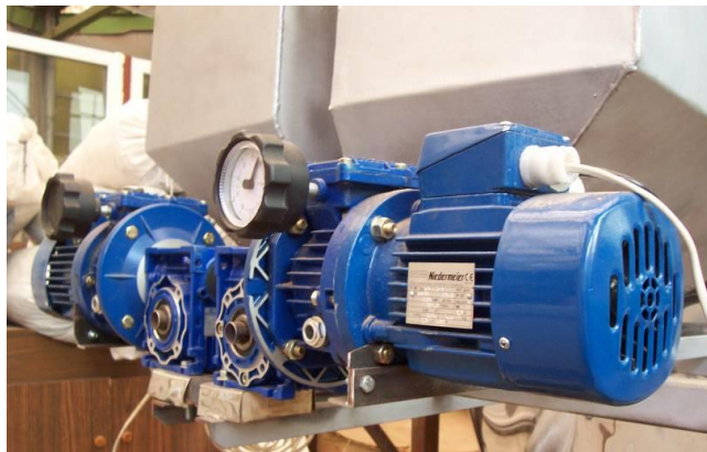
Fig. 4.8. Buncăre de combustibil și motoare de c.a.
