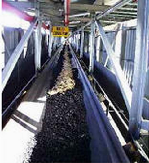
Fig. 3.19. Amestecul de biomasă cu cărbune pe banda transportoare [95]
