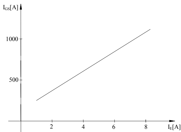
Fig.2.44. Dependentă curentului la GS de curentul de excitație.
