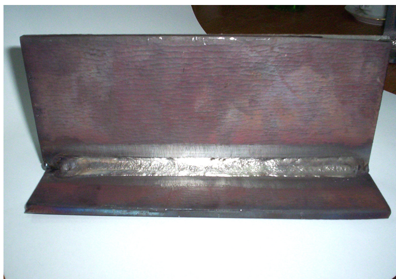
Fig. 4.11. Aspectul suprafeței sudurii după îndepărtarea stratului de oxid
