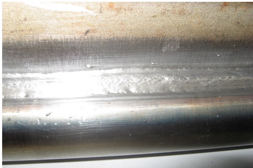
Fig. 5.11. Aspectul suprafeței după periere – detaliu
