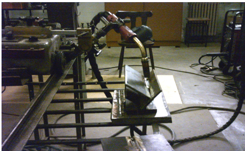
Fig. 4.8. Poziționarea pistolului de sudare și a probei
