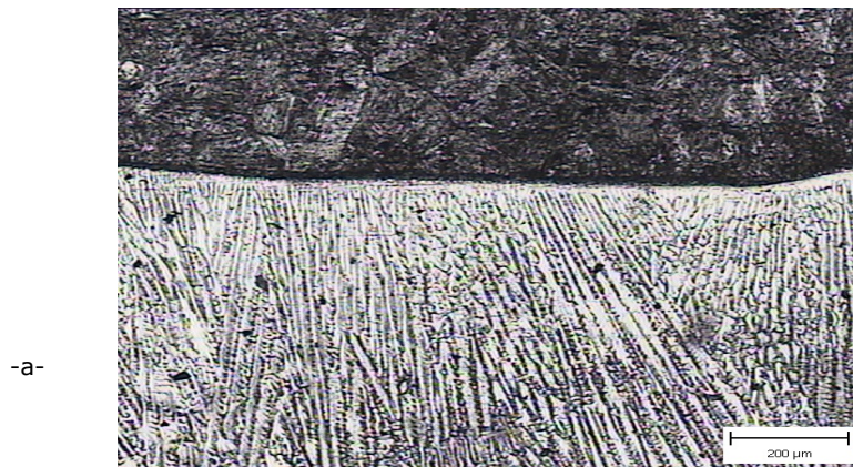
Fig. 5.15. Micrografia cusăturii sudate
