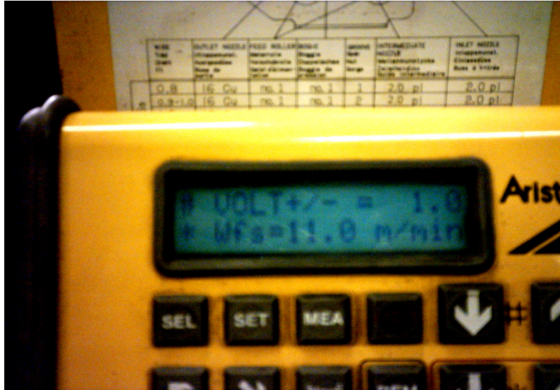
Fig. 4.9. Setarea parametrului sinergic, v_{as} = 11\text{m/min}
