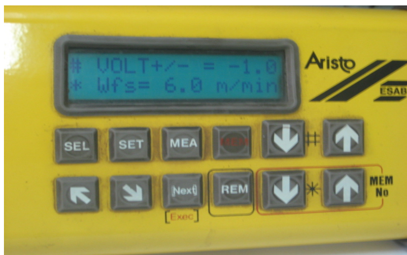
Fig. 5.5. Optimizarea vitezei de avans a sârmei electrod
