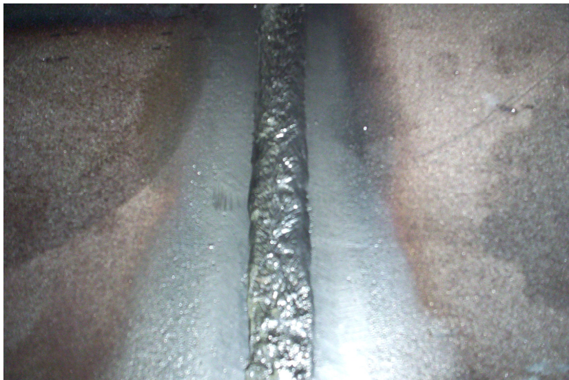
Fig. 4.18. Detaliu al suprafeței sudurii
