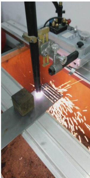
Figura 4.6 Tăierea cu plasmă în timpul procesului
