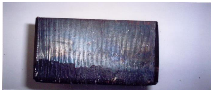
Figura 5.28 Imagine suprafață probă tăiată: s = 80\text{mm} , d = 8\text{mm} , p_{O_2} = 5,6\text{ bar} , v_t = 280\text{mm/min}
