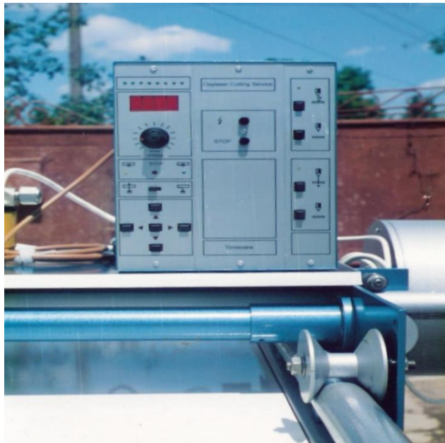
Figura 4.14 Echipamentul electric de comandă
