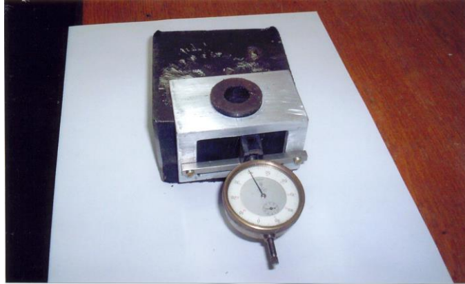
Figura 5.29 Dispozitiv pentru măsurarea toleranței la perpendicularitate și a înălțimii neregularităților în zece puncte pe suprafața tăiată oxigaz
