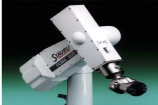
Figura 2.25 Varianta constructivă a arhitecturii superioare a unui robot[100]
