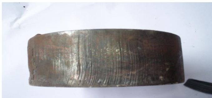
Figura 5.19 Imagine suprafață probă tăiată: s = 25\text{mm} , d = 8\text{mm} , p_{O_2} = 7\text{ bar} , v_t = 550\text{mm/min}
