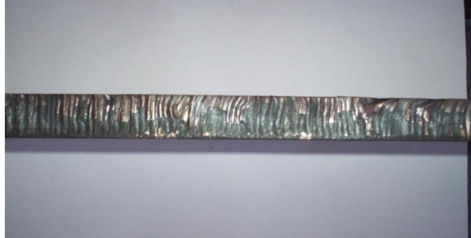
Figura 5.23 Imagine suprafață probă tăiată: s = 10\text{mm} , d = 8\text{mm} , p_{O_2} = 6\text{ bar} , v_t = 630\text{mm/min}
