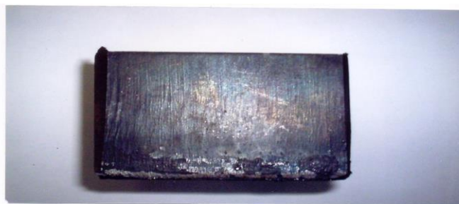
Figura 5.27 Imagine suprafață probă tăiată: s = 80\text{mm} , d = 8\text{mm} , p_{O_2} = 8,4\text{ bar} , v_t = 280\text{mm/min}
