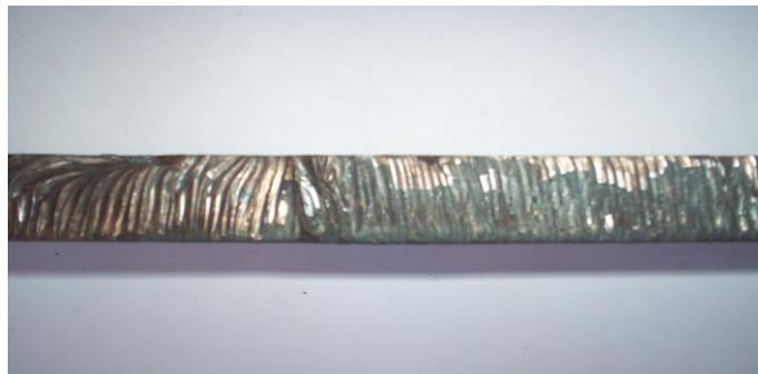
Figura 5.24 Imagine suprafață probă tăiată: s = 10\text{mm} , d = 6\text{mm} , p_{O_2} = 4\text{ bar} , v_t = 630\text{mm/min}
