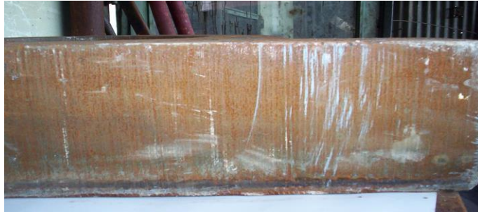
Figura 5.21 Imagine suprafață probă tăiată: s = 80\text{mm} , d = 10\text{mm} , p_{O_2} = 7\text{ bar} , v_t = 280\text{mm/min}
