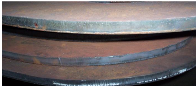
Figura 5.8 Imagine suprafață probă tăiată: s = 10 \text{ m} , d = 6 \text{ mm} , p_{O_2} = 5 \text{ bar} , v_t = 630 \text{ mm/min}
