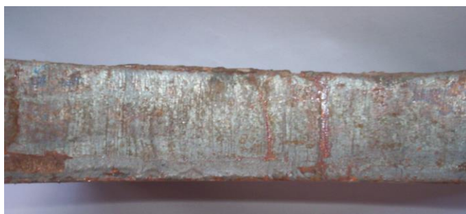
Figura 5.20 Imagine suprafață probă tăiată: s = 25\text{mm} , d = 3\text{mm} , p_{O_2} = 7\text{ bar} , v_t = 550\text{mm/min}
