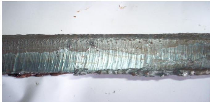
Figura 5.13 Imagine suprafață probă tăiată: s = 25\text{mm} , d = 6\text{mm} , p_{O_2} = 7\text{ bar} , v_t = 440\text{mm/min}
