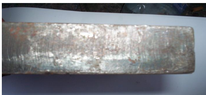
Figura 5.10 Imagine suprafață probă tăiat: s= 10\text{mm} , d = 6\text{mm} , p_{O_2} = 5 \text{ bar} , v_t = 504\text{mm/min}
