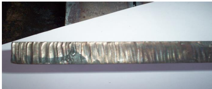
Figura 5.26 Imagine suprafață probă tăiată: s = 25\text{mm} , d = 6\text{mm} , p_{O_2} = 5,6\text{ bar} , v_t = 550\text{mm/min}
