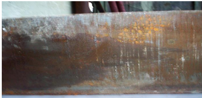
Figura 5.22 Imagine suprafață probă tăiată: s = 80\text{mm} , d = 6\text{mm} , p_{O_2} = 7\text{ bar} , v_t = 280\text{mm/min}
