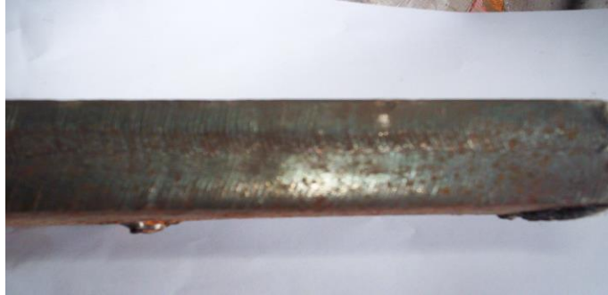
Figura 5.12 Imagine suprafață probă tăiată: s = 25\text{mm} , d = 6\text{mm} , p_{O_2} = 7\text{ bar} , v_t = 660\text{mm/min}
