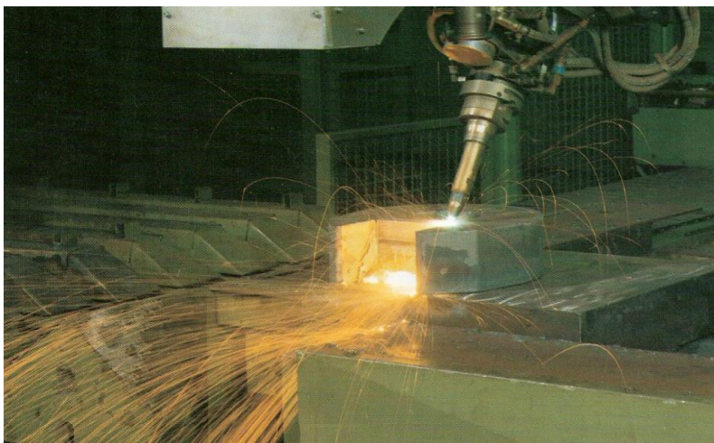
Figura 2.28 Debitare înclinată executată cu un robot într-o placă de oțel tip S355JR cu grosimea de 150 mm [100]
