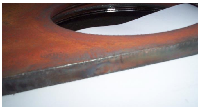
Figura 5.11 Imagine suprafață probă tăiat: s=25\text{mm} , d = 6\text{mm} , p_{O_2} = 7 \text{ bar} , v_t = 550\text{mm/min}
