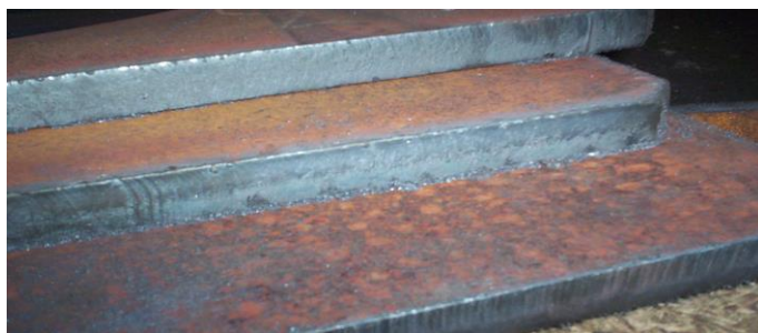
Figura 5.9 Imagine suprafață probă tăiat: s= 10\text{mm} , d = 6\text{mm} , p_{O_2} = 5 \text{ bar} , v_t = 756\text{mm/min}
