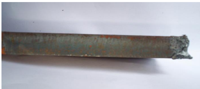
Figura 5.17 Imagine suprafață probă tăiată: s = 10\text{mm} , d = 8\text{mm} , p_{O_2} = 5\text{bar} , v_t = 630\text{mm/min}
