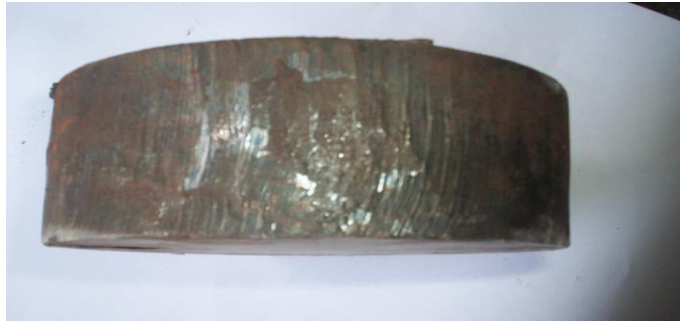
Figura 5.15 Imagine suprafață probă tăiată: s = 80\text{mm} , d = 8\text{mm} , p_{O_2} = 7\text{ bar} , v_t = 336\text{mm/min}
