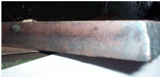
Figura 5.18 Imagine suprafață probă tăiată: s = 10\text{mm} , d = 3\text{mm} , p_{O_2} = 5\text{ bar} , v_t = 630\text{mm/min}
