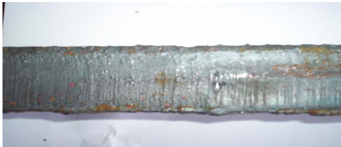
Figura 5.16 Imagine suprafață probă tăiată: s = 80\text{mm} , d = 8\text{mm} , p_{O_2} = 7\text{ bar} , v_t = 224\text{mm/min}
