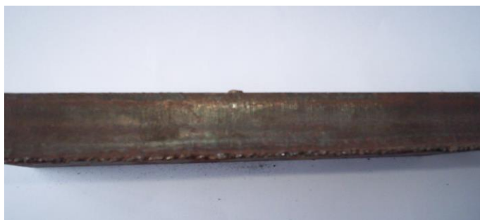
Figura 5.25 Imagine suprafață probă tăiat: s = 25\text{mm} , d = 6\text{mm} , p_{O_2} = 8,4\text{ bar} , v_t = 550\text{mm/min}
