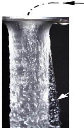
Fig.1.12 Perturbarea suprafeței jetului datorată mișcărilor secundare
