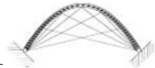
fig.3.6.4b Galeria comercială GUMS - sistemul de arc cu tiranți oblici avea să marcheze un spațiu extrem de interesant. Elementele liniare de mare finețe se pierd pur și simplu în lumina puternică, impresia lăsată fiind aceea a unei uriașe pânze de păianjen
