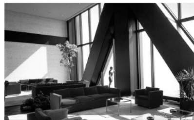
fig.3.7.7b John Hancock Center - prin introducerea sistemelor de contravântuire la nivelul fațadei, se obțin tuburi rigide cu componente suple, care permit suprafețe vitrate substanțial mai mari. Ceea ce ar putea părea un dezavantaj, necesitatea conceperii unor componente speciale atât la nivel de structură cât și de închidere, poate fi utilizat în folosul arhitecturii pentru îmbogățirea limbajului expresiv.
