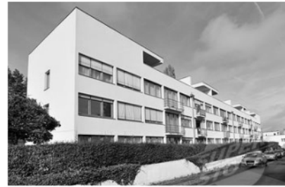
fig.2.4.5e Bloc de locuințe în Weissenhof , STUTTGART, Germania (1927) - arh. Mies van der Rohe - conceput pe o structură scheletală de oțel cu închideri din cărămidă cu goluri verticale, permitea o utilizare flexibilă a apartamentelor. Acestea erau gândite ca un plan liber, în care compartimentările rămăneau la latitudinea fiecărui chiriaș sau proprietar.
