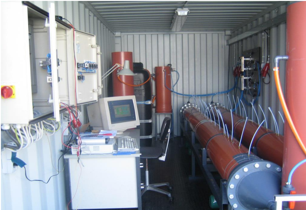
Fig.5.7. Vedere de ansamblu asupra instalației realizată la scară redusă pentru simularea proceselor de tratare [21],[83]
