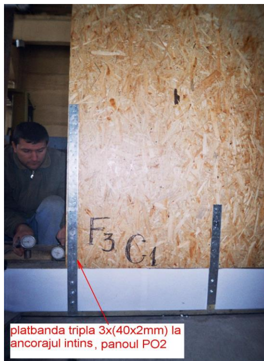
Fig. 7.9- Ancorajul din zona întinsă a panoului PO2 a fost întărit pentru a determina cedarea panoului la nivelul plăcii de OSB.
