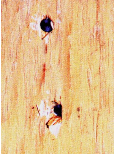
Fig.5.12 – Cedarea peretelui de forfecare ca urmare a penetrării capului cuiului prin placa de OSB.
