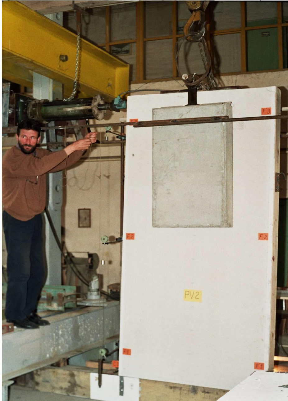
Fig.8.11 – Deplasările orizontale și verticale vizibile față de firul cu plumb.
