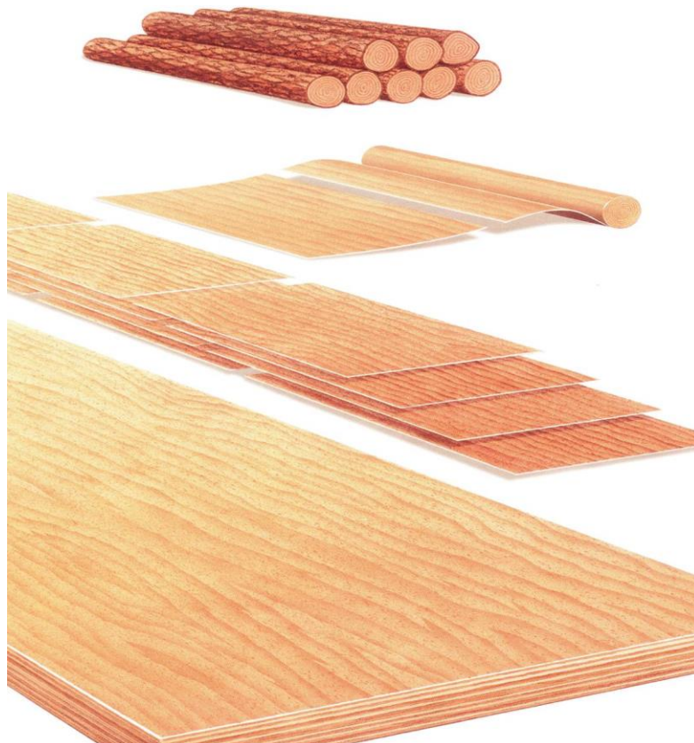
Fig.1.21 – Confecționarea plăcilor din care se realizează elementele de tip Microllam.
