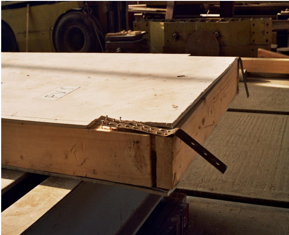
Fig. 8.6. – Smulgerea cuielor din montantul fisurat.
