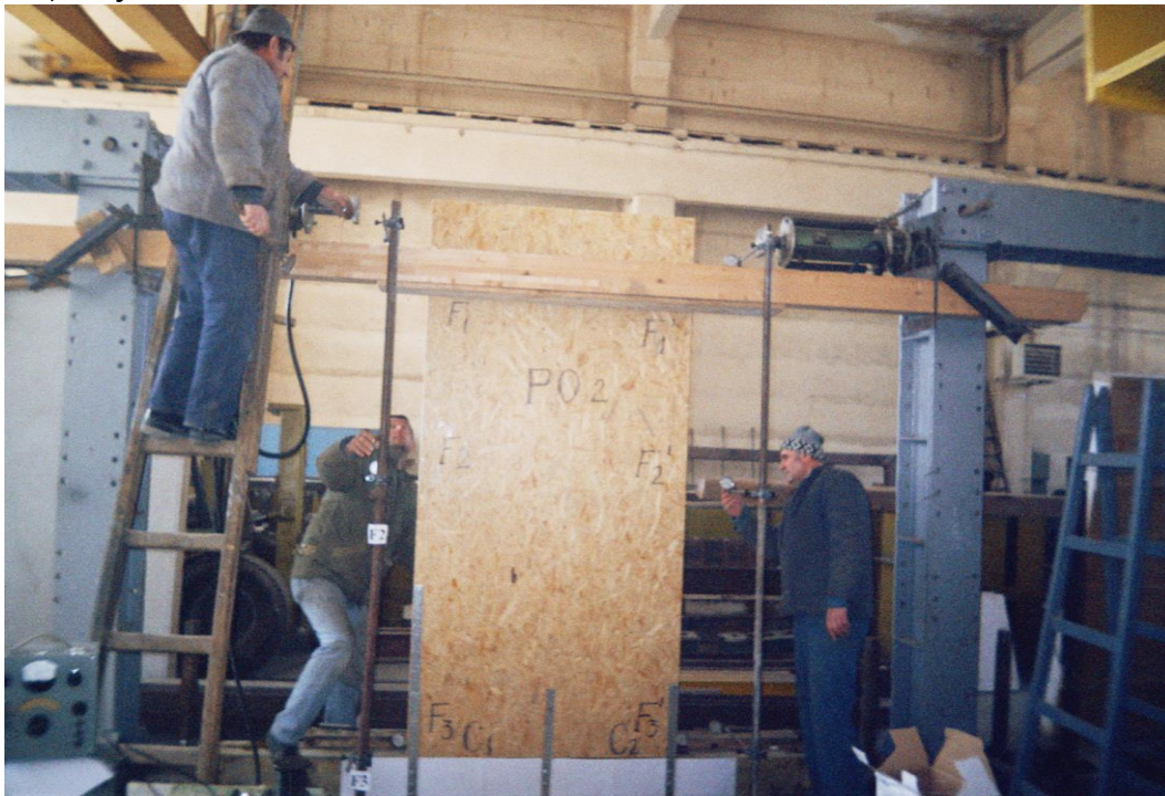
Fig. 7.4 - Aspect din timpul montajului panourilor in standul de încercare.
