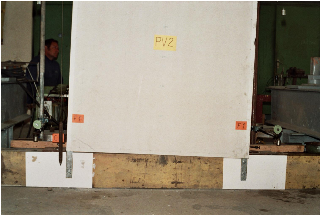
Fig. 8.12 – Aspectul panoului pe grinda standului de încercare la treapta maximă de încărcare
