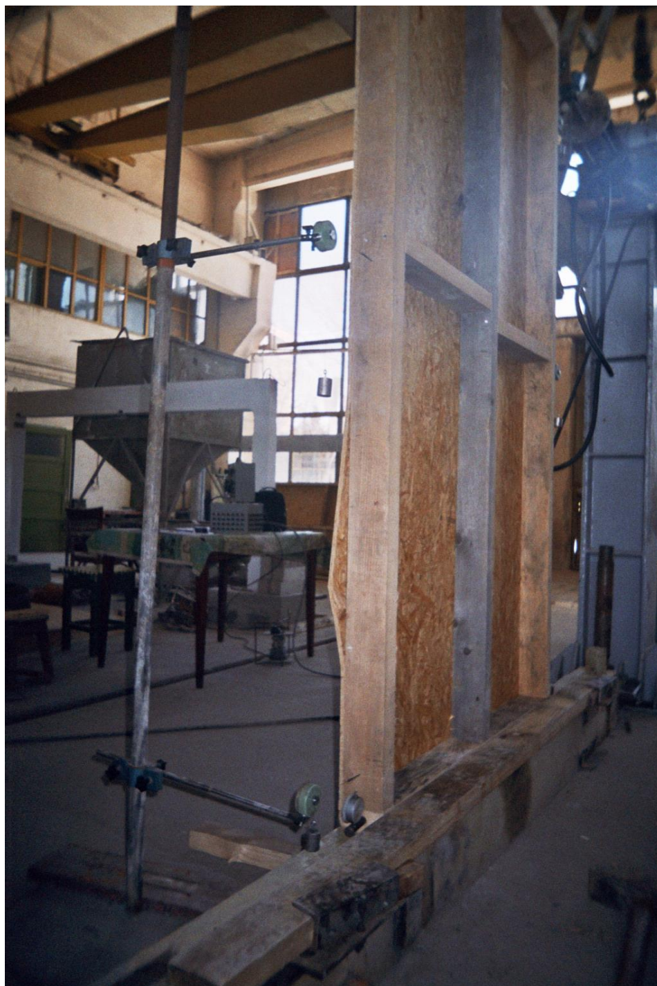
Fig.7.10 - Cedarea panoului PO2 prin penetrarea cuielor prin placa de OSB.
