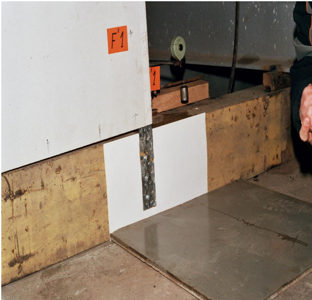
Fig.8.4. – Ruperea ancorajului la panoul PV1.
