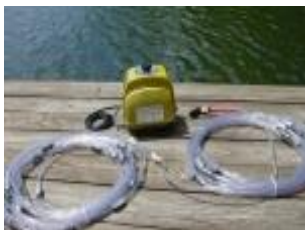
Fig. 4.55 Aerator cu difuzori
