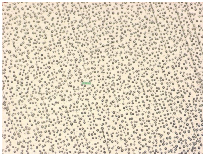
Fig. 2.6. Analiza particulelor de ceață generate cu mașina de fum FOG B-500
