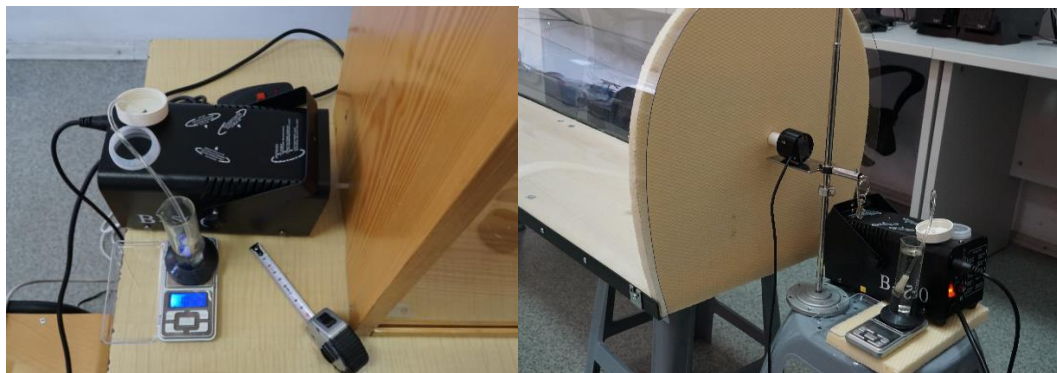
Fig. 2.5. Mașina de generat fum FOG B-500
