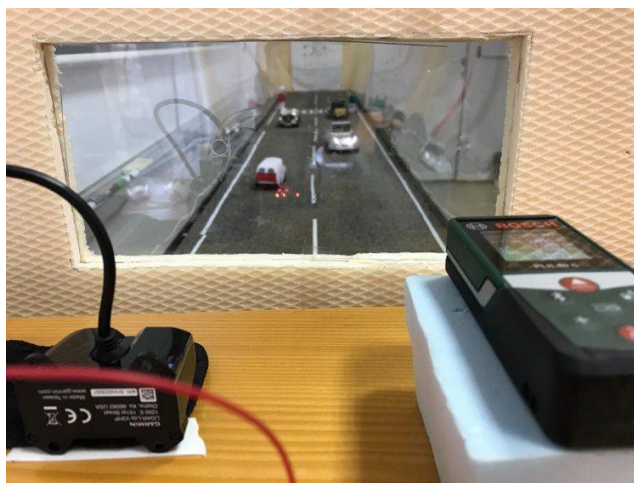
Fig. 5.38 Evaluarea rezultatelor lidarului și telemetrului în diferite condiții de ceață
