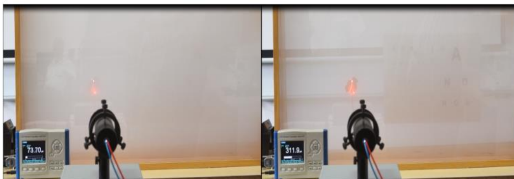
Fig. 5.28 Configurația cu strat de ceață: a) Condiții cu ceață densă; b) Condiții cu ceață moderată
