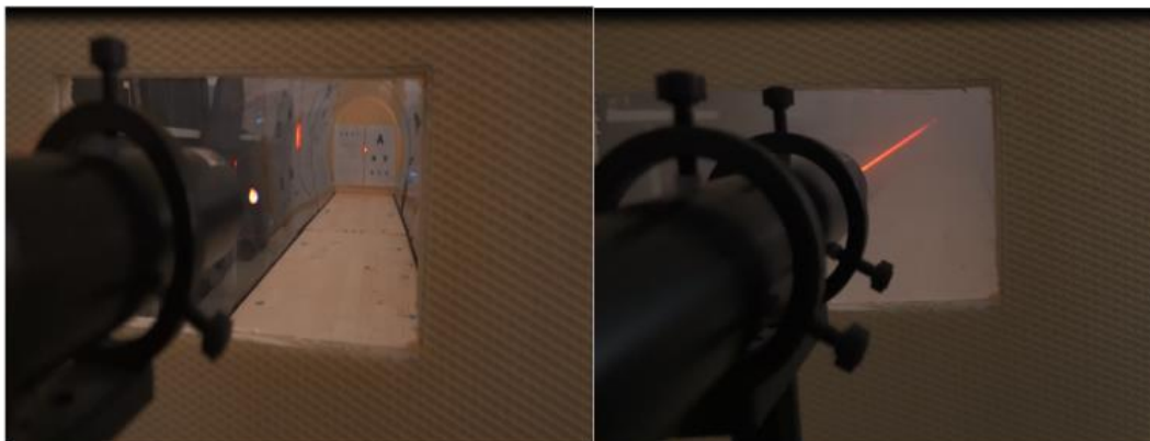
Fig. 5.29 Configurația cu rază lungă: a) Condiții fără ceață; b) Condiții cu ceață
