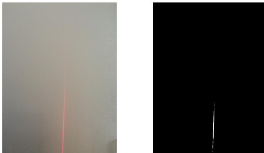
Fig. 5.13 Condiții de zi cu ceață densă: a). Imagine originală; b). Imagine procesată
