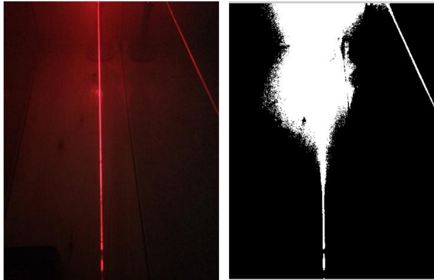
Fig. 5.14 Condiții de noapte fără ceață: a). Imagine originală; b). Imagine procesată
