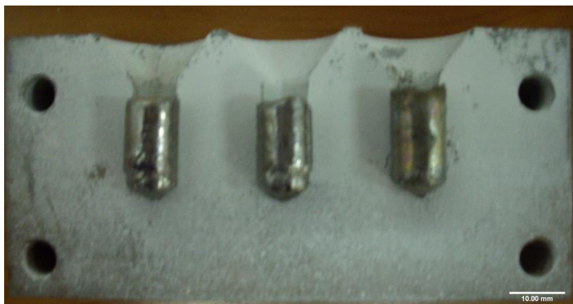
Figura 4.2 Aliaj primar și cochilă pentru obținerea aliajului primar
