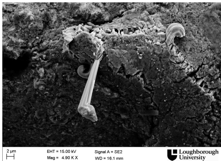
Figura 6.6 Excrescențe whiskers la aliajul \text{Sn}_{95}\text{Cu}_2\text{Co}_3 la lipirea cu ciocanul de lipit pe cupru
