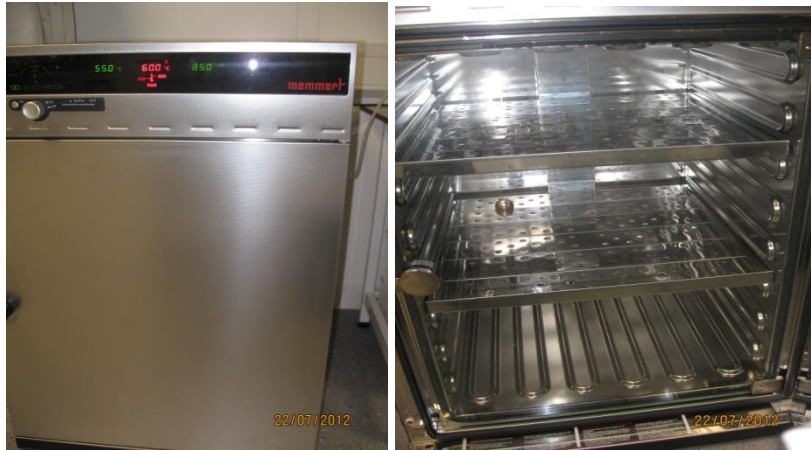
Figura 6.1 Incubator pentru accelerarea excrescențelor whiskers
