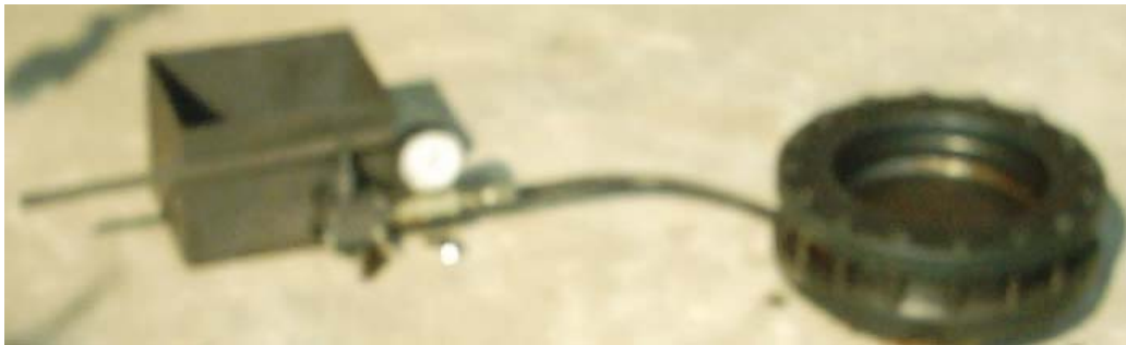
Fig.4.1. Instalația experimentală pentru deformarea plastică hidraulică a plăcilor subțiri încastrate pe contur
