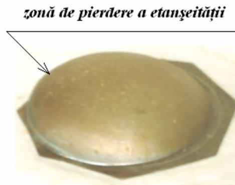
Fig.4.5. Exemplu de defect de prelucrare cu alunecării semifabricatului
