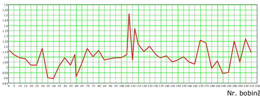
Figura 8.12. Variația factorului de pierderi dielectrice \text{tg } \delta la 0,8 U_n în funcție de numărul de bobine
