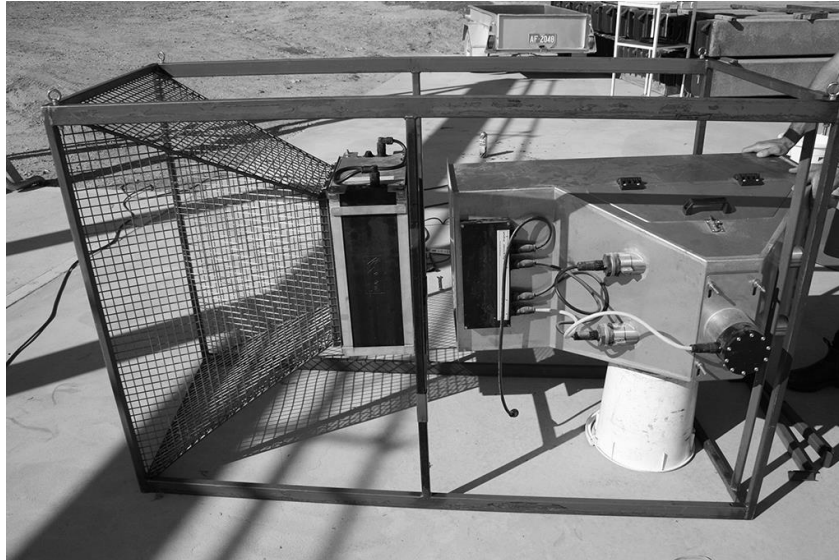
Figura 4.28. Sistem automat de numărat pești VAKI Riverwatcher. Sursa: http://www.finterest.com.au
