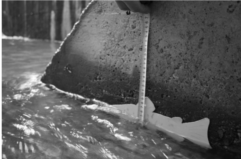
Figura 6.15. Captarea Sebeșel I, nivel de apă scăzut pe radierul de beton, chiar și în cazul în care MHC este oprită. 25.10.2012. Foto: P. Molnar.
