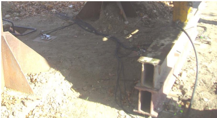
Fig. 6.71 Vedere sistem de aplicare încărcări statice și amplasare senzori triaxiali
