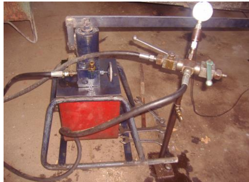
Figura 6.35 Pompă hidraulică cu manometru și senzor de presiune
