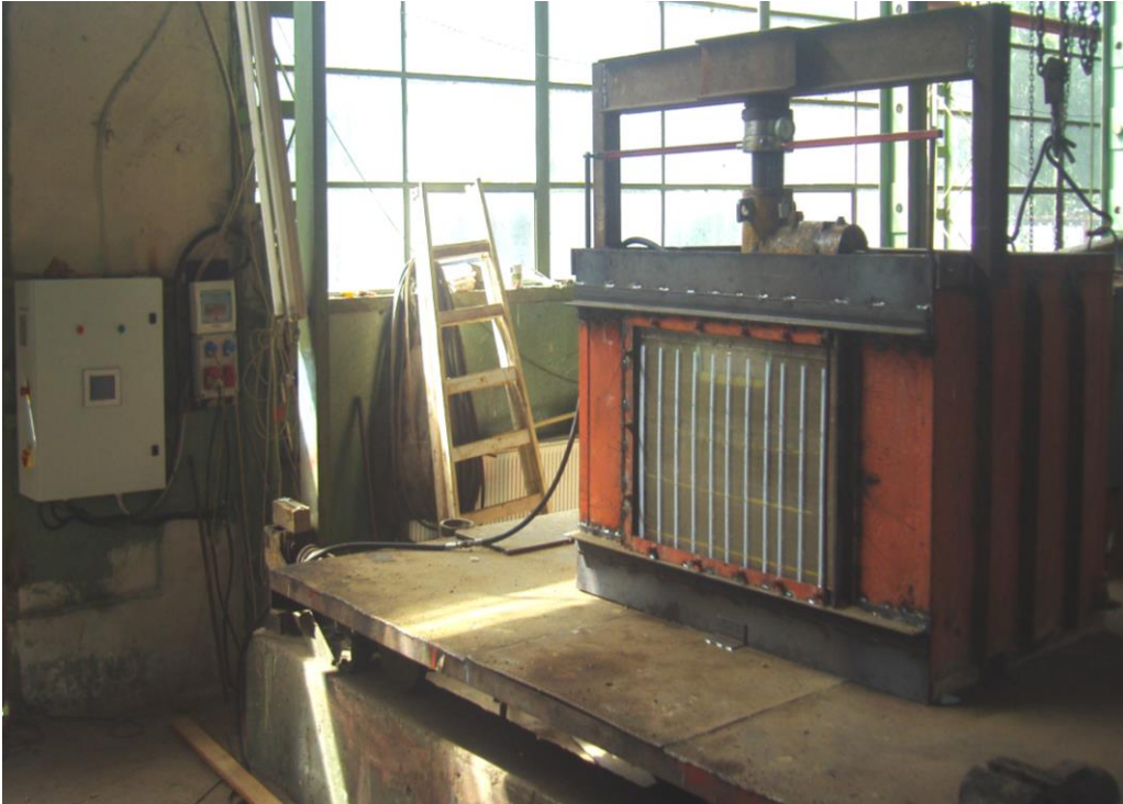
Fig. 6.33 Ansamblu sistem de încărcare: Cuvă – Platformă – Tablou de comandă
