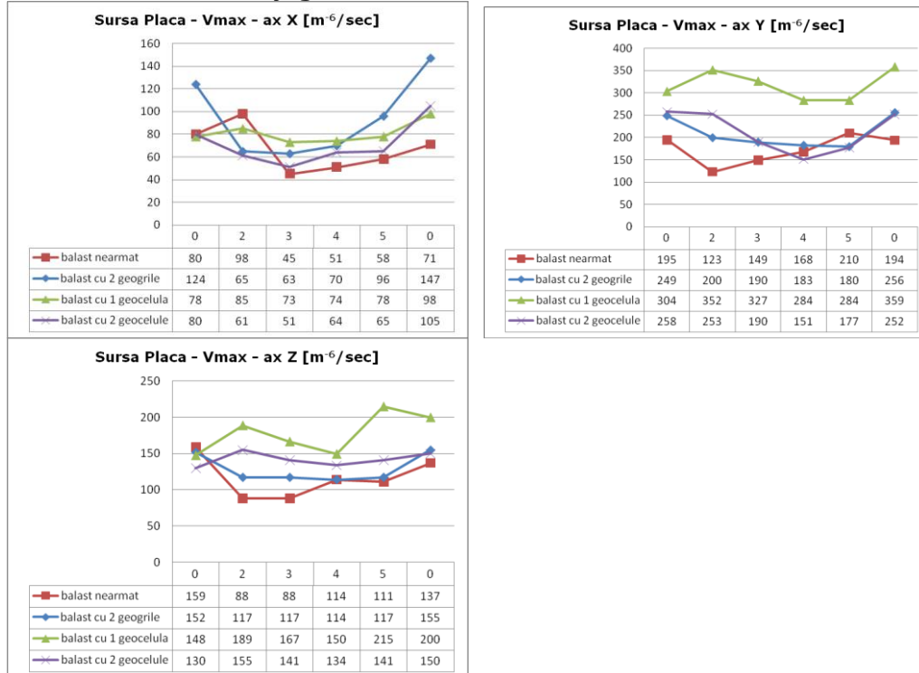
Fig. 6.103 Valori maxime în balast a) pe axa X, b) pe axa Y, c) pe axa Z,
