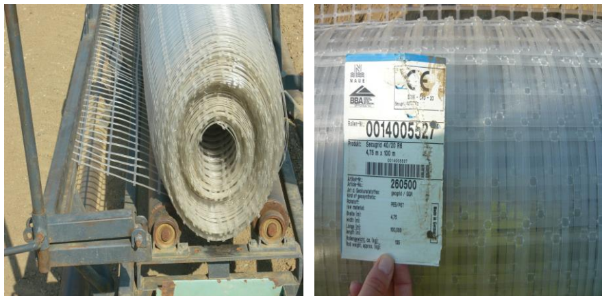
Fig. 2.14 Ambalare și detalii tehnice pentru geogriile [90]
