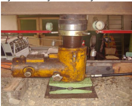
Figura 6.34 Detaliu sistem de încărcare: plăcuțe cu rol – cric – comparatoare
