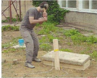
Fig. 6.81 Generarea undelor primare P [23]
