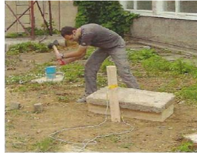
Fig. 6.82 Generarea undelor secundare S [23]
