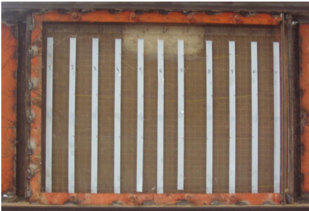
Fig. 6.28 Vedere frontală a cuvei pentru încercări – evidențierea deformației maxime
