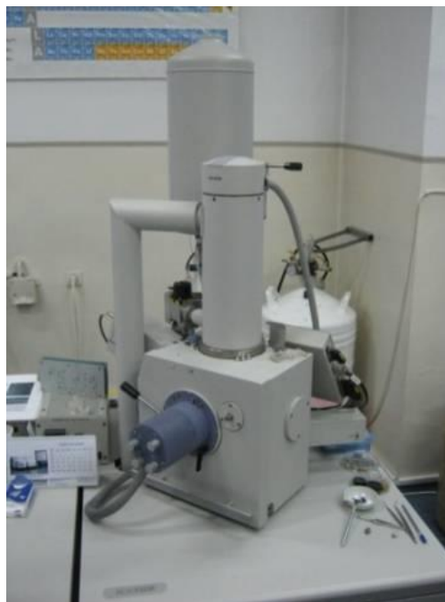
Fig. 2.4 Microscopul electronic cu baleiaj Philips XL 30 ESEM
