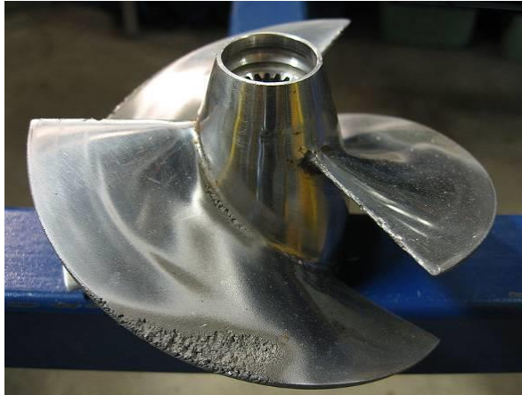
Fig. 1.6 Elice de șalupă distrusă prin eroziune cavitațională, [66]
