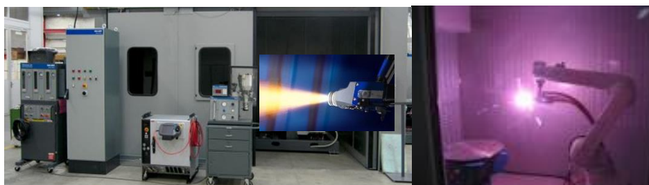
Fig. 7.1 Instalație de pulverizare termică robotizată METCO SULZER
