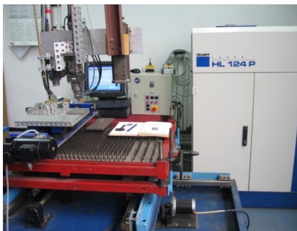
Fig.6.1 Instalația laser (Nd-YAG, Trumpf HL 124 P) folosită pentru tratarea probelor
