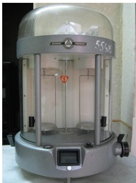
Fig. 2.9 Balanța analitică de tip Zatkłady Mechaniki Precyzyjnej WP 11
