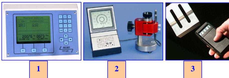
Fig. 2.42 Echipamente și aparatură de calibrare electroultraacustică 1. Sonometru măsurare frecvență de rezonanță și impedanță acustică 2. Modul digital de măsurare a amplitudinii de vibrație ultrasonică 3. Senzor de măsurare a frecvenței de rezonanță în timp real
