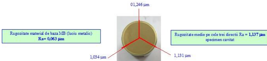
Fig.5.6 Direcții de măsurare pe suprafața erodată prin cavitație (după 165 minute) – aparat MITUTOYO
