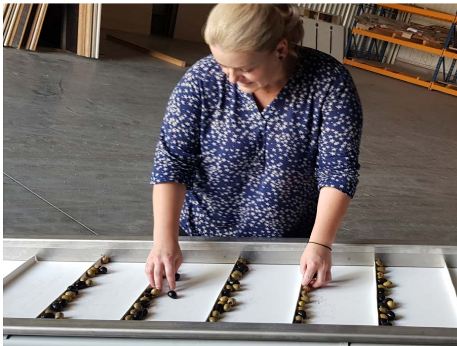
Fig. 2.15. Sortarea manuală de pe benzi transportoare
