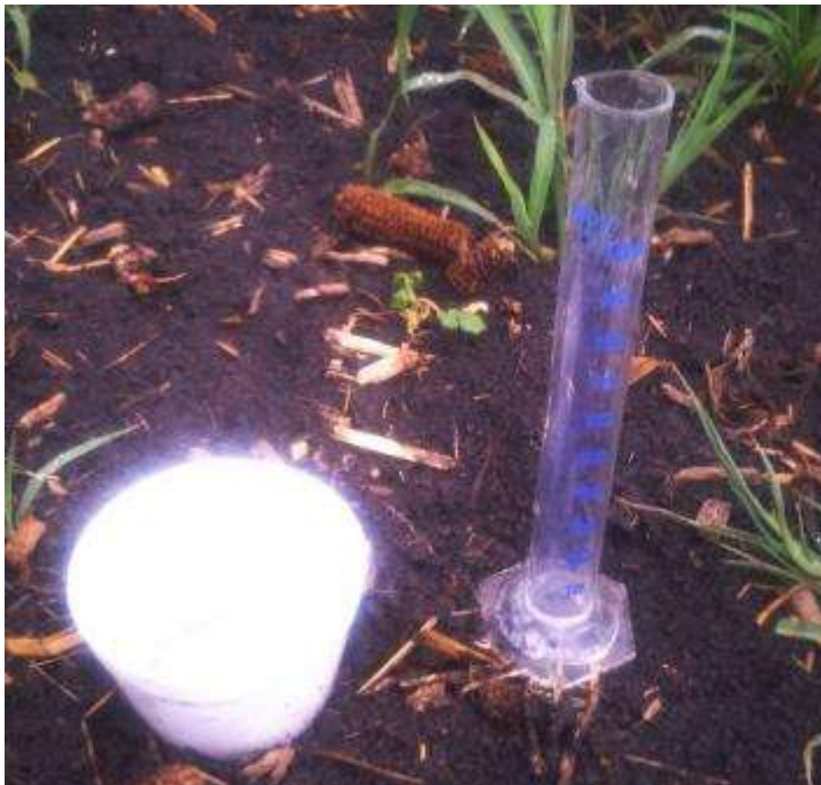
Figura 128 Recipient circular cu diametru d = 11 cm și cilindru gradat folosite pentru colectarea și măsurarea probelor
