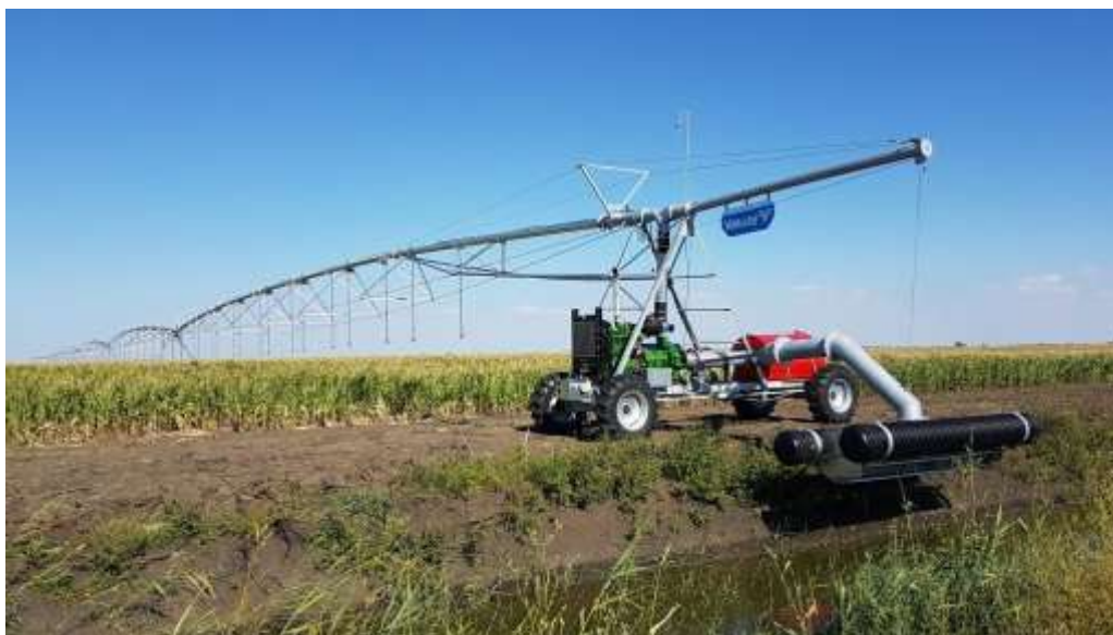
Figura 67 Instalație de irigații prin aspersiune cu deplasare liniară
