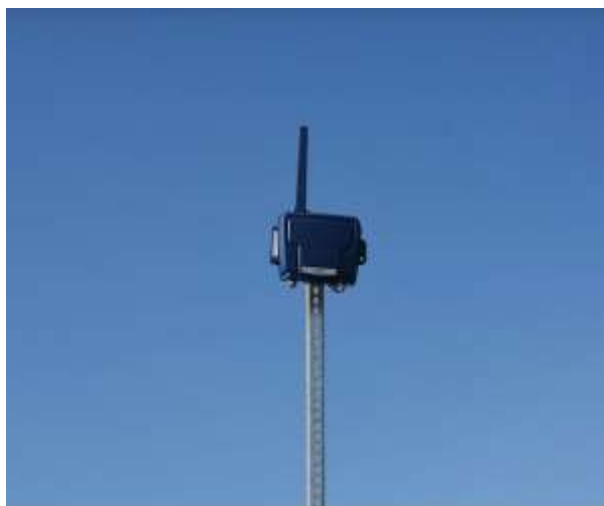
Figura 85 Sistem de colectare date R-link [126]
