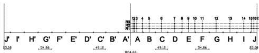
Figura 130 Schema de amplasare a pluviometrelor pe instalația de irigație prin aspersiune cu deplasare liniară [62]
