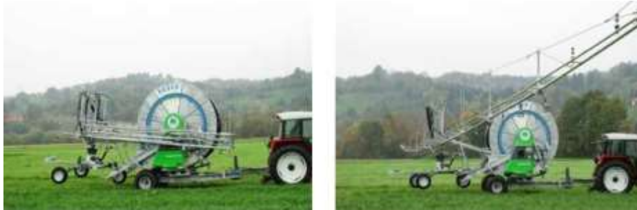
Figura 51 Transportul instalației de irigat cu tambur și furtun și rampă de udare [123]
