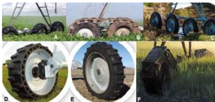
Figura 65 Unități de acționare auto – deplasabile cu 3 roți (A), cu șenilă și articulație (B), cu 4 roți cu profil îngust (C), cu pneuri fără aer (D), cu pneuri nedirecționale (E) și șenilă Raaft (F)[127]
