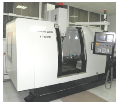
Figura 4.18. Mașina de frezat în 3 axe, cu comandă numerică CNC YT 800FM
