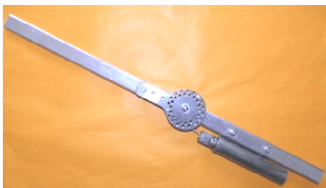
Figura 4.21. Dispozitivul pentru tensionarea ortezei fixe de noapte
