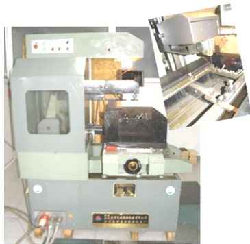
Figura 4.17. Mașina de prelucrare prin electroeroziune cu fir DK7732F
