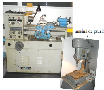
Figura 4.20. Echipamentele utilizate pentru realizarea suportului pentru înglobarea arcului
