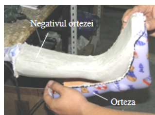
Figura 4.7. Desprinderea ortezei de pe negativ
