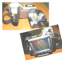
Figura 2.35. Termograful Flir B 200
