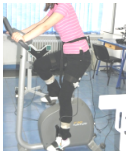
Figura 3.33. Bicicleta ergometrică F 30 TUNTURI și markerii sistemului Zebris atașați pe membrele inferioare
