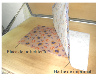
Figura 4.5. Dezlipirea hârtiei imprimate de pe placă
