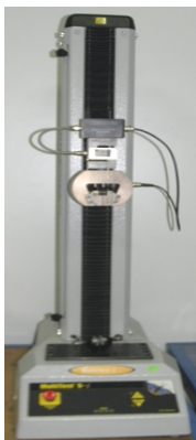
Figura 4.22. Sistemul de încercare la tracțiune MultiTest 5- i
