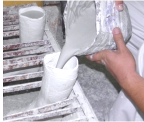
Figura 4.1. Turnarea gipsului în mulaje
