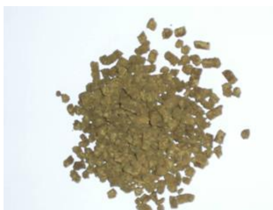
Fig.4.2. Granule prepolimerice din biocompozit 100% natural pe bază de biorășini termoreactive ranforsate cu puzderii măcinate de cânepă
