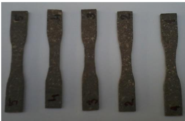
Fig.4.66. Epruvete folosite pentru încercarea la tracțiune pentru materialul cu 75% puzderii de cânepă sub formă de praf fin ;15% măcinatură de HDPE;
