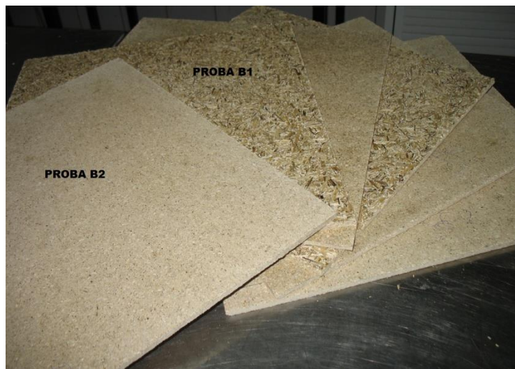
Fig. 4.7. Plăci biocompozite cu 87% puzderii de cânepă nemăcinate (proba B 1) și 87% puzderii măcinate (proba B2) pe bază de rășini melamino-formaldehidice(13%)
