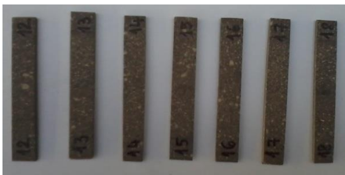
Fig.4.67 Epruvete folosite pentru încercarea la încovoiere pentru materialul cu 75% puzderii de cânepă sub formă de praf fin ;15% măcinatură de HDPE;
