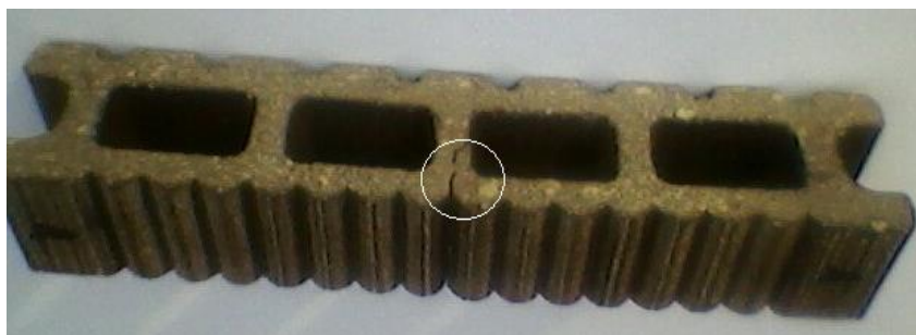
Fig.5.20 Vizualizarea rupei la încercarea experimentală
