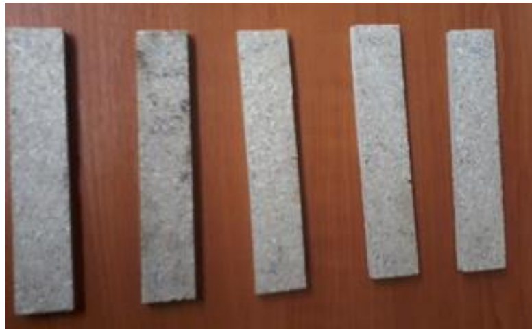
Fig. 4.40 Epruvetele încercate la încovoiere din material biocompozit pe bază de rășină melamino-formaldehidică (13%) ranforsat cu 87% puzderii măcinate de cânepă
