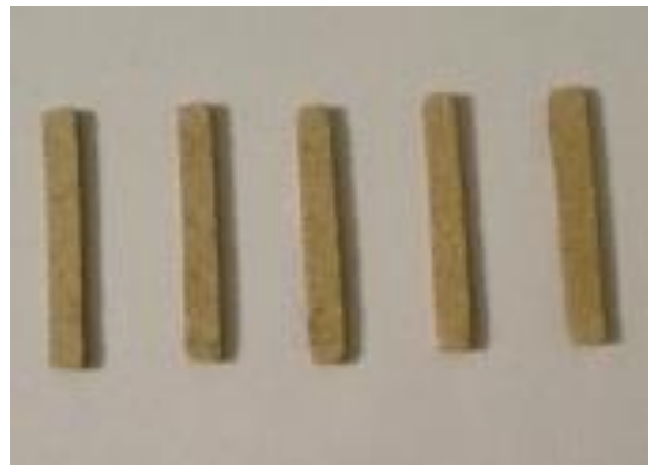
Fig.4.35 Epruvete pentru încercarea la încovoiere realizate din materialul compozit pe bază de 17% rășini melamino-formaldehidice ranforsate cu 83% puzderii de cânepă sub formă de praf fin (PCPF), Proba I.A.2
