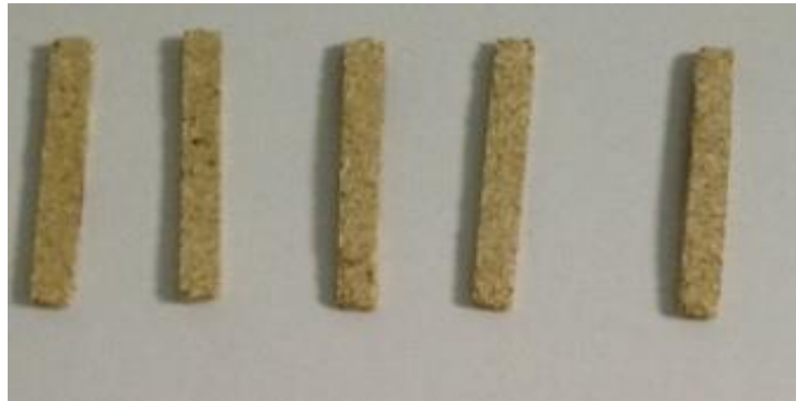
Fig.4.34. Epruvete pentru încercarea la încovoiere realizate din materialul compozit pe bază de 17% rășini melamino-formaldehidice ranforsate cu 83% puzderii de cânepă sub formă de praf grosier (PCPG), proba I.A.1
