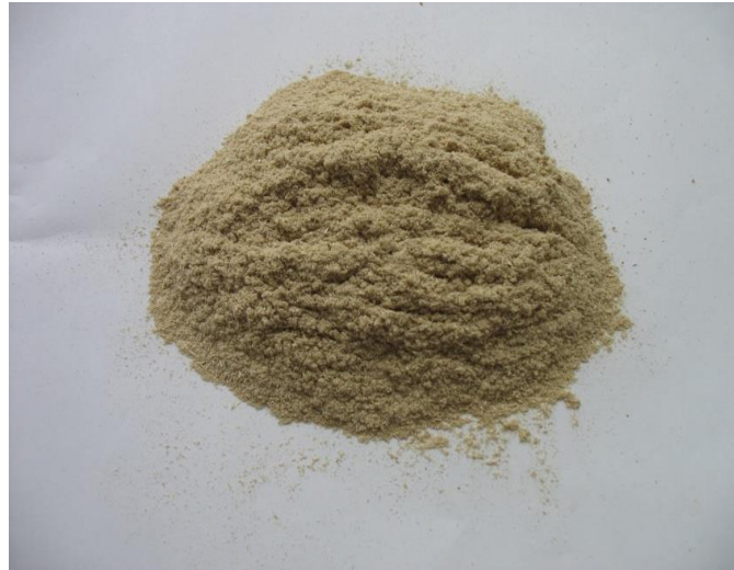
Fig.4.6. Amestec compozit cu puzderii de cânepă și rășină melamino-formaldehidică
