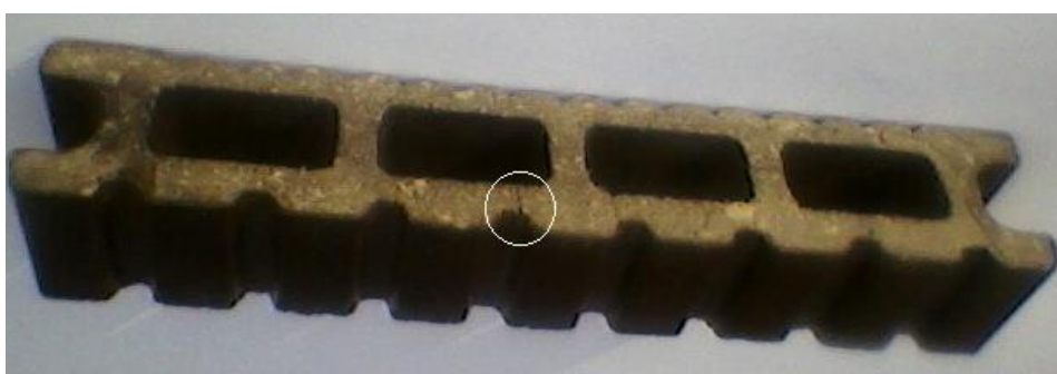
Fig.5.15 Vizualizarea ruperii la încercarea experimentală
