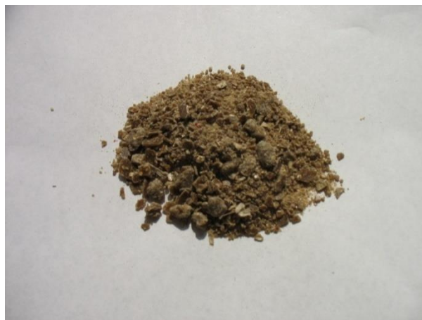
Fig.4.13.Granule compozite din PP și puzderii de cânepă sub formă de praf fin Compoziții ale materialului compozit pe bază de PP ranforsat cu puzderii de cânepă sub formă de praf fin (Probele 1,2,3,4)
