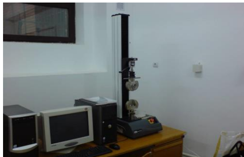
Fig.4.19. Aparat INSTRON pentru determinarea rezistenței la tracțiune
