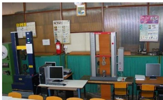
Fig.4.20. Mașina de încercat Zwick/Roell Z005 pentru determinarea rezistenței la tracțiune și a rezistenței la încovoiere
