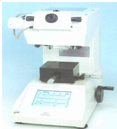
Fig. 4.17. Aparat pentru determinarea duritatii Vickers (Shimadzu, Japonia)
