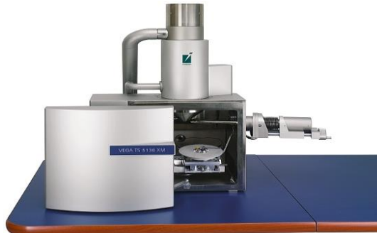
Fig.4.18. Microscop electronic cu baleaj VEGA II Tescan pentru determinarea structurii morfologice ale suprafețelor materialelor compozite
