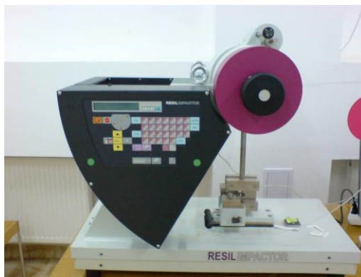
Figura 4.16. Aparat pentru determinarea rezistenței la impact Charpy produs de firma CEAST – Italia
