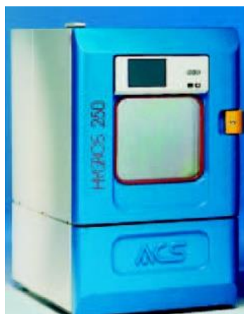
Fig. 4.21. Camera climatică Angelantoni Industrie (Italia), model CH 250 E pentru determinarea capacității de absorbție a umidității și a comportamentului la îmbătrânire
