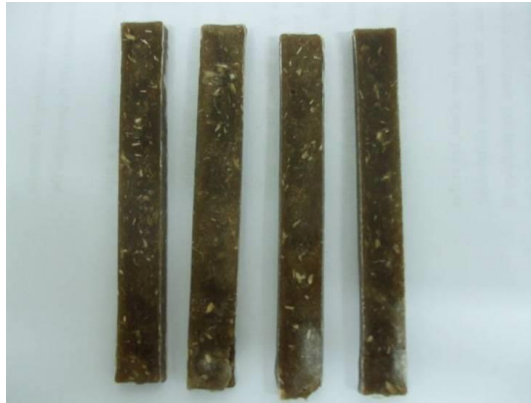
Fig.4.22. Epruvetele din biocompozite pentru încercarea la impact
