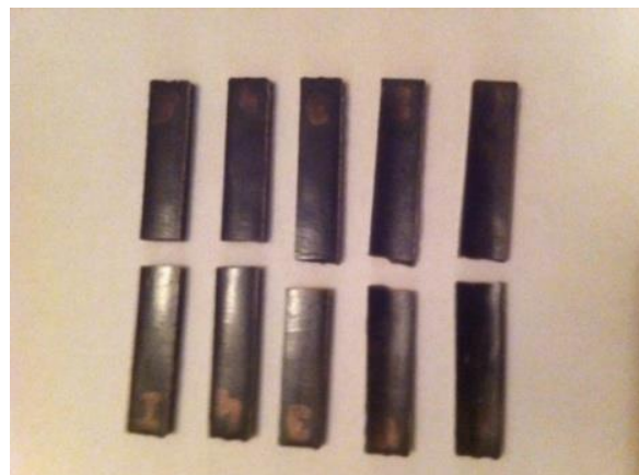
Fig.4.52. Epruvete încercate la încovoiere pentru materialul P3(57% PP J 700 + 3% PP-MA + 40% PCPF)
