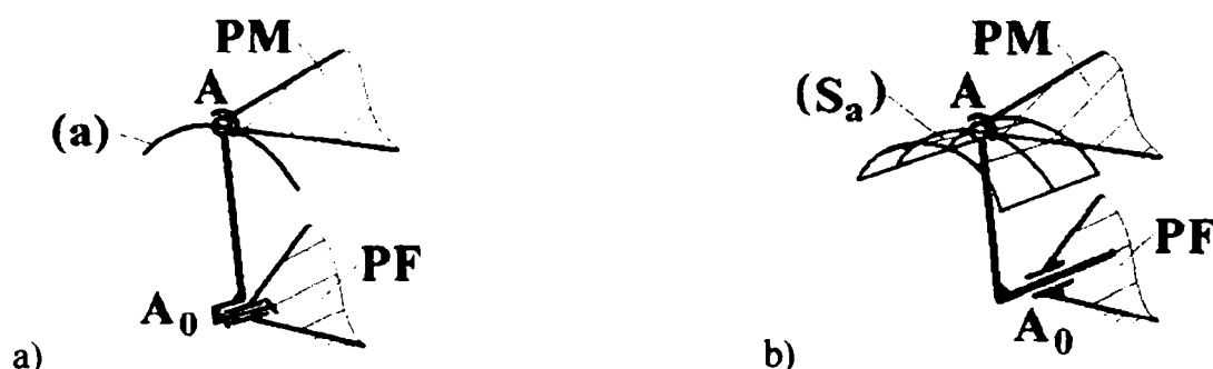
Fig. 2.11. Punctul A (centrul cuplei cinemate sferice), ghidat pe o curbă în spațiu (a), sau pe o suprafață în spațiu (b).
