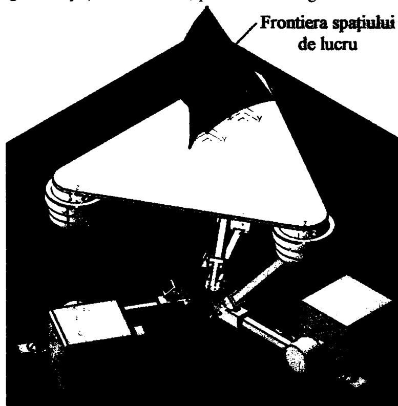
Fig. 4.44. Frontiera spațiului de lucru al mecanismului dispozitivului de ghidare cu topologie paralelă având structura PF_3 + 3 \times RRS + PM_3 .
