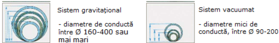
Fig. 4.31 Diametre de conductă
