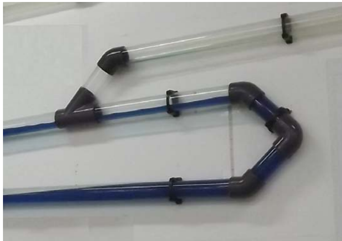
Fig. 3.8 Curgere inversă la racordurile în Y , cu unghi de 45°, cu cot de întoarcere cu L < 6,5 m
