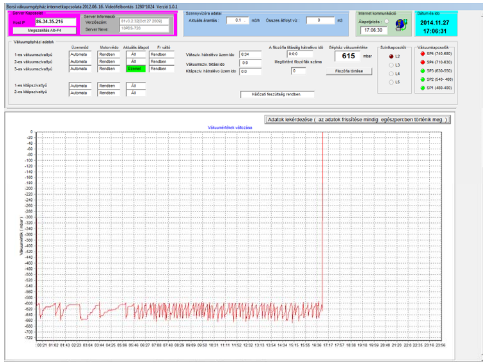
Fig. 5.18 Interfață funcționare stației de vacuum din Borș-2 pompe vacuum – prin internet
