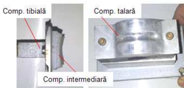
Figura 4.11 Componentele prelucrate ale protezei de gleznă
