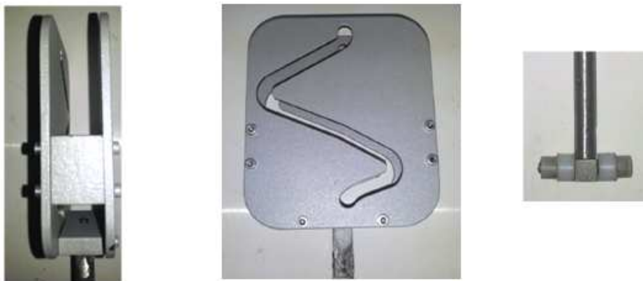
a. Ansamblu camă – vedere laterală b. Ansamblu camă – vedere frontală c. Ansamblu tchet frontală
