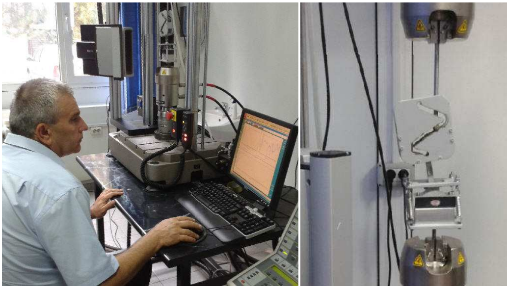
a. Standul echipamentului INSTRON 8800
