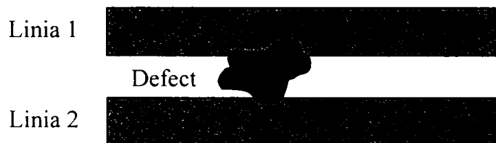
Figura 2.4 – Defect de tip scurt-circuit între două linii de interconectare
