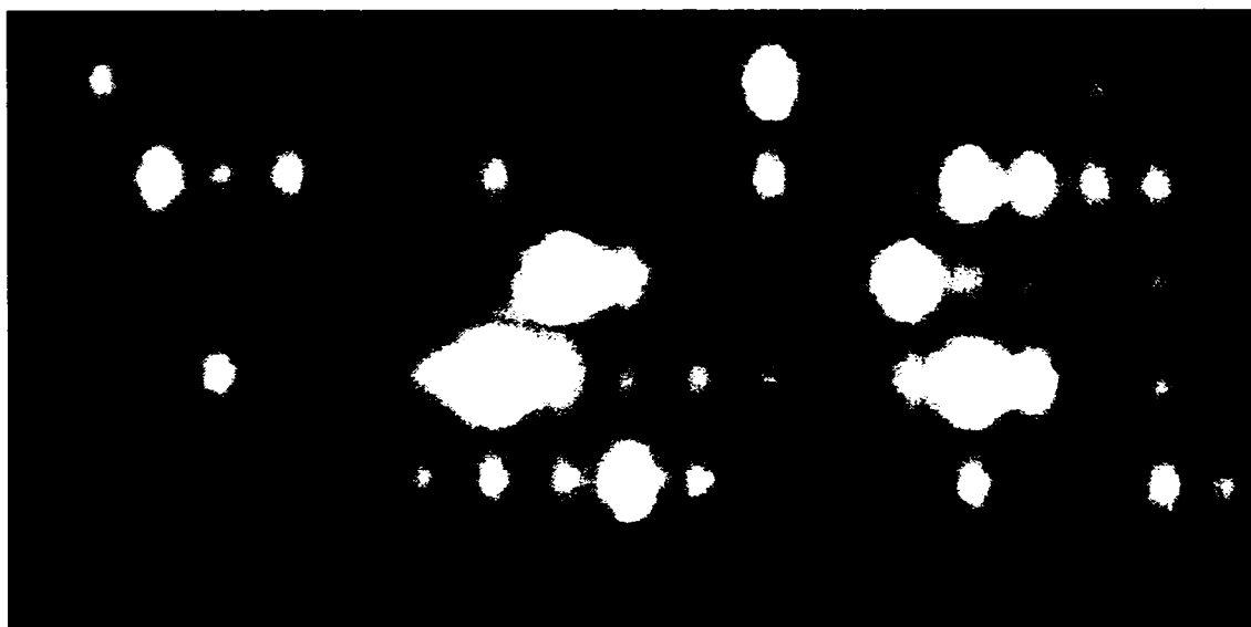
Figura 3.44 – Imaginea termică a unei plăci cu circuite integrate cu defecte
