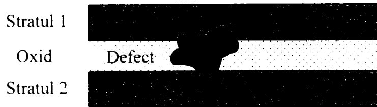
Figura 2.8 – Defect de tip scurt-circuit între două straturi de metalizare
