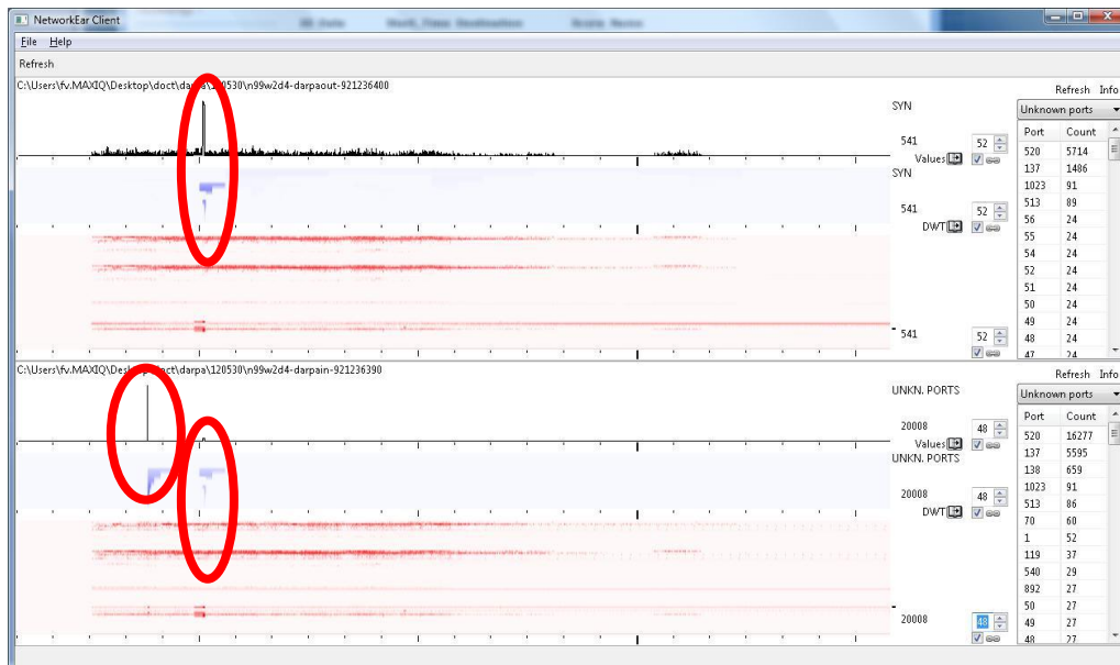
Figura 76. Atac neptune din exterior și SATAN din interior pe seriile n99w2d4. Seria de sus este capturată în exterior, seria de jos este capturată în interior. Atacul din stânga pe seria de jos este SATAN.
