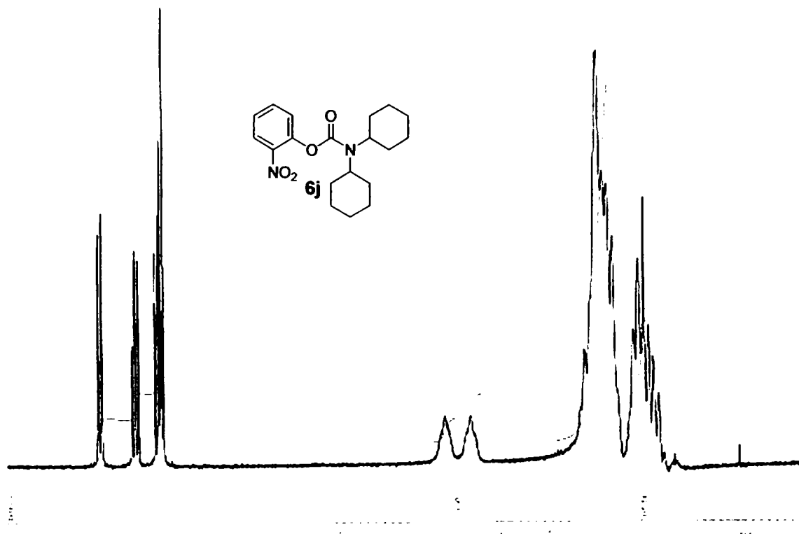
Figura 48. Spectrul ^1\text{H} RMN (200 MHz, \text{CDCl}_3 ) al compusului 6j
