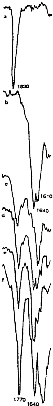
FIG.1 OBTINEREA DPC DIN TFG ȘI 2HP URMĂRIREA REACȚIEI PRIN SPECTROSCOPIE DE IR (1500-1900 \text{cm}^{-1} )
